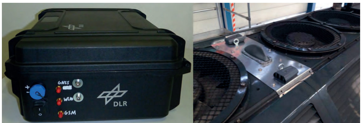
Abb. 4: Der autarke Prototyp (links) findet in einem üblichen Technikoffen Platz und wurde in einem freien Bauraum auf dem Dach des DFZ (rechts) installiert.
