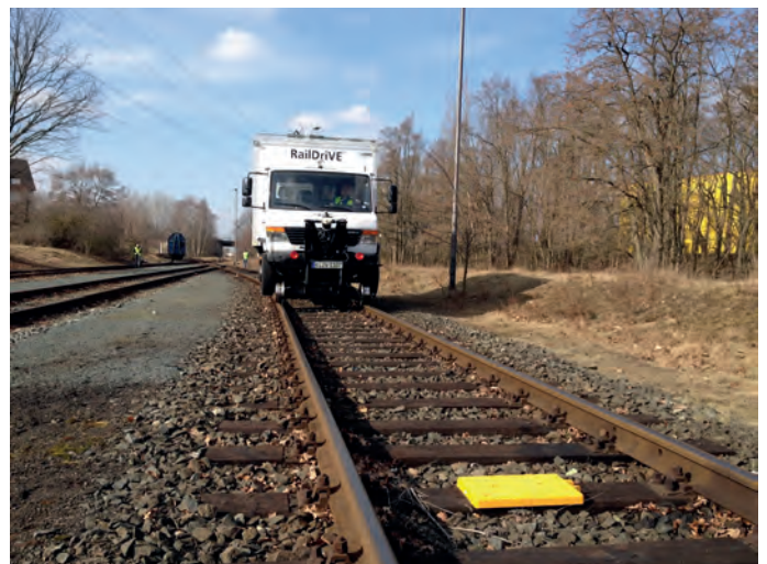
Abb. 8: Das Zwei-Wege-Fahrzeug RailDrIVE [10] und eine Balise als ortsfeste Infrastrukturkomponente (gelb)
