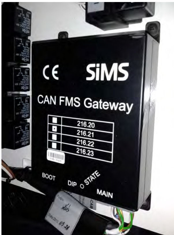
Abbildung 5: Foto des FMS-CAN Gateway im Bus der BSVAG
