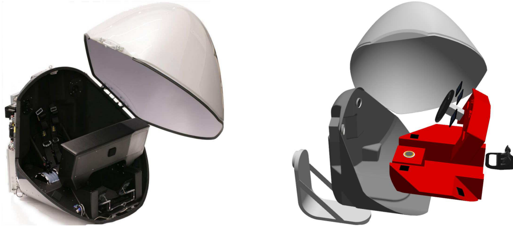
Abbildung 2.3: Die Simulatorzelle des DLR Robotic Motion Simulators mit Fahrzeuginstrumententräger (links). Die Komponenten der Zelle (rechts); Quelle: [Bel14].
