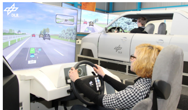
BILD 14 Finale Version des Fahrstreifenwechselsassistenten mit Head Up Display unter Verwendung einer transportablen Konfiguration der Simulationsplattform MoSAIC (vorne Fahrzeug V2, hinten Fahrzeug V1, demonstriert auf der D3CoS Abschlussveranstaltung).
