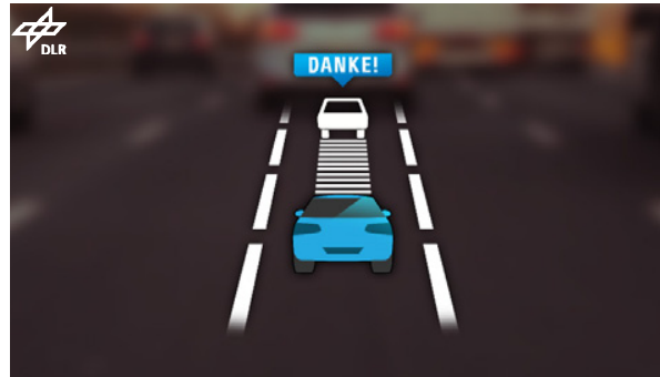
BILD 13 C-LCA HMI aus Sicht von Fahrzeug V2 bei Beendigung der Kooperation inklusive einer Danksagung von V1 für den erfolgreich durchgeführten kooperativen Fahrstreifenwechsel
