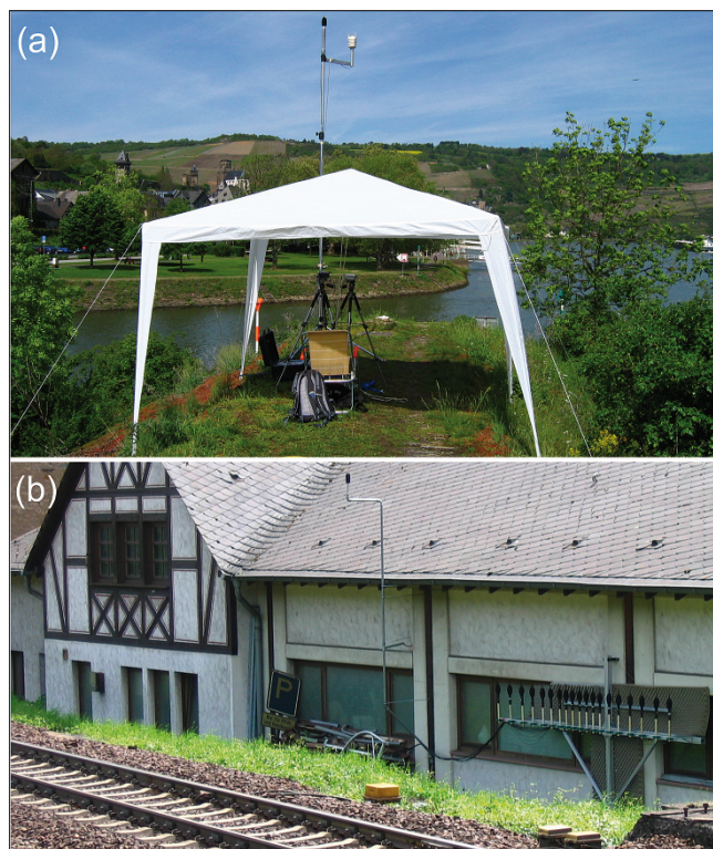
Bild 2 (a) Messposition P01 (Mole) mit meteorologischer und akustischer Sensorik. (b) Messposition E (Bahnhof) mit Messstelle des Landes Rheinland-Pfalz (mittig) und linearem Mikrofon-Array (rechts) neben der linksrheinischen Bahnstrecke.
