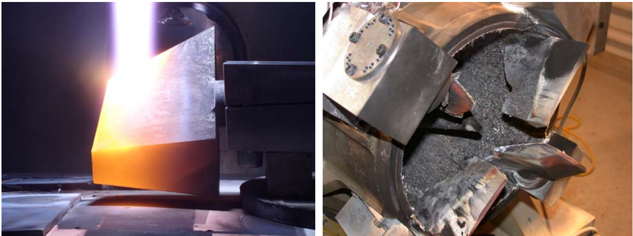
Abb.6: Strahlruder aus C/C-SiC in einer Plasmabeschichtungsanlage des DLR (Thermoschocktest) sowie nach einem typischen Raketenmotortest (Temperaturen > 2000\text{ °C} , Heißgas verbrannte Aluminiumpartikel) mit einer Testdauer von wenigen Sekunden.
