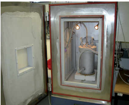
Bild 3: Experimentkammer (im Klimaschrank unter Marsbedingungen) und Sensorentwicklungen
