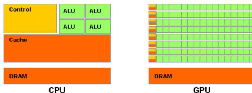
Abbildung 1: Aufbau von Grafik- und Hauptprozessor [10]
