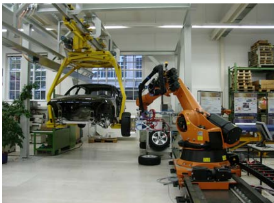
Bild 1: links: Gesamtansicht mit einem auf einer Linearachse montierten KUKA-Roboter und einer durch eine Elektro-Hängebahn transportierte Karosserie; rechts: Detailansicht des Endeffektors mit nachgiebigem Kraft-Momenten-Sensor
