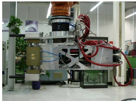
Bild 1: links: Gesamtansicht mit einem auf einer Linearachse montierten KUKA-Roboter und einer durch eine Elektro-Hängebahn transportierte Karosserie; rechts: Detailansicht des Endeffektors mit nachgiebigem Kraft-Momenten-Sensor
