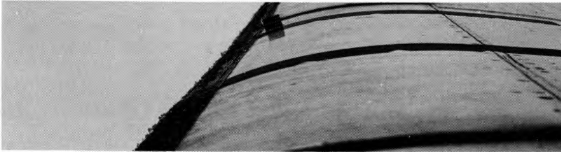
Bild 11: Maximaler Eisansatz auf der Tragflächenoberseite
