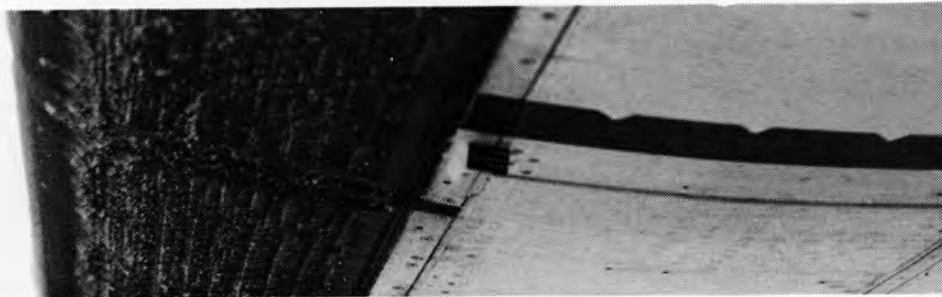
Bild 6: Maximaler Eisansatz an der Tragflächenunterseite
