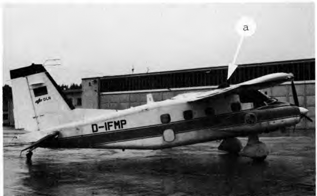
Bild 1: Das Forschungsflugzeug der DLR vom Typ Do 28 mit Gehäuse einer Kleinbildkamera zum Photographieren der Tragflächenoberseite (a).
