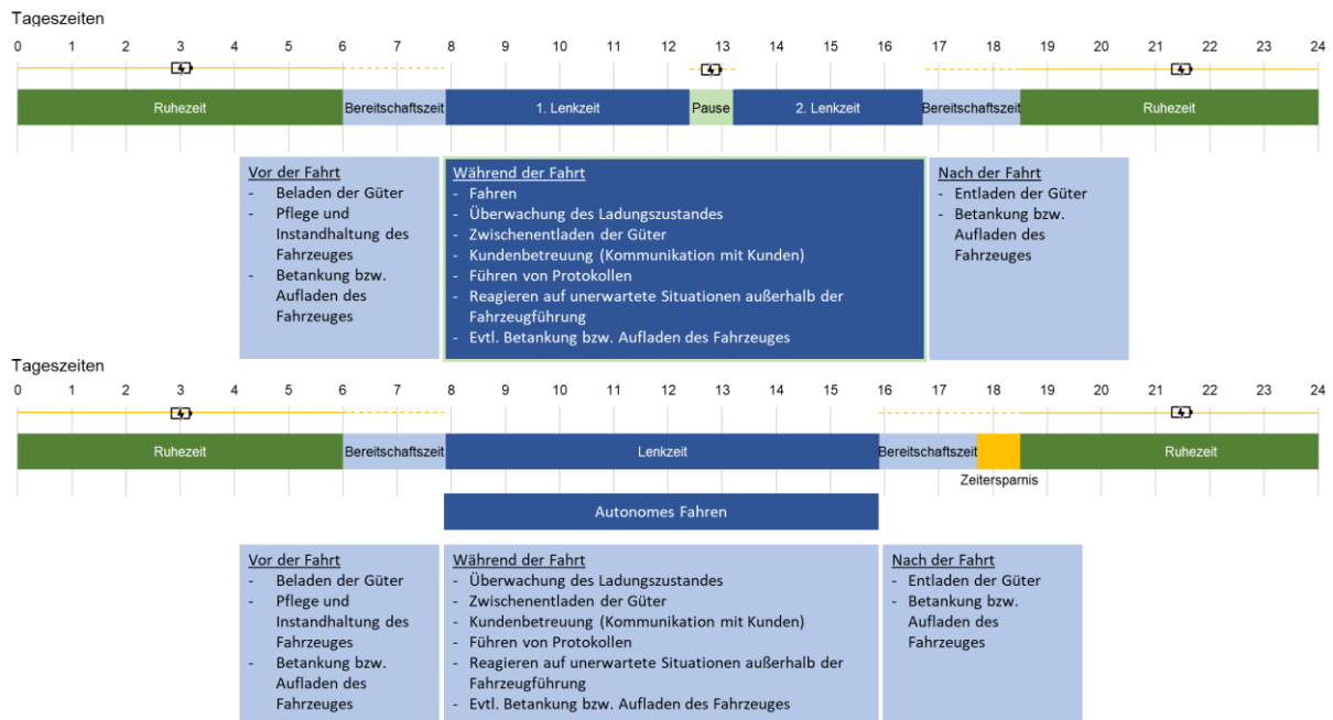
Abbildung 14: Vergleich der zeitlichen Einsatzprofile einer typischen Transportaufgabe mit menschlicher und autonomer Fahrzeugführung unter Berücksichtigung von Ladezeiten (eigene Darstellung)
