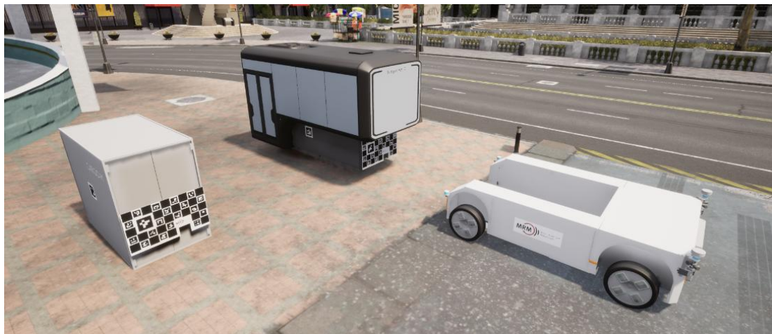
Abbildung 46: Simulationsumgebung in CARLA mit simuliertem funktionalem Driveboard, einer Cargokapsel und einer Personenkapsel. (Bild: © [13])
