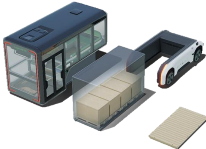
Abbildung 1: Modularer Ansatz des U-Shift Konzepts: flexible Kombination diverser Kapseln mit einem Driveboard (Bild: DLR, CC BY-ND)
