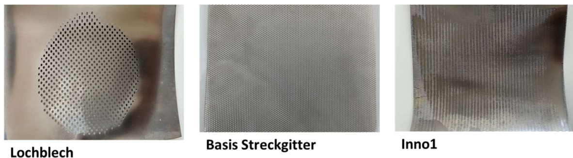
Abbildung 12: Mittels Sinterverfahren beschichtetes gelochtes Nickelband, Basis Streckgitter und speziell auf das Sinterverfahren angepasstes Nickelsubstrat (Inno1).
