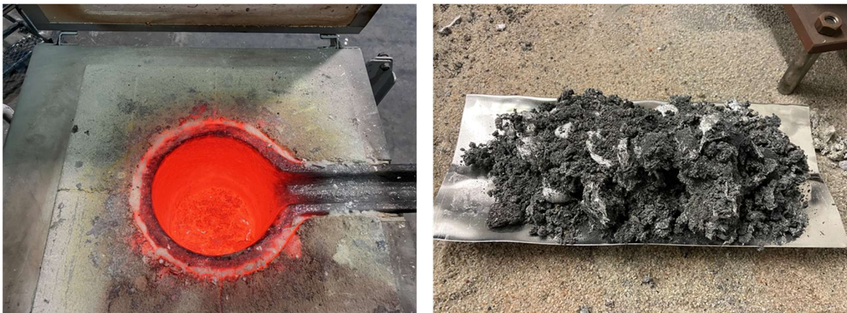
Abbildung 9: Einschmelzversuch von Überkorn-Pulver im KSG Technikumsgießofen bei 1100°C an Luft
