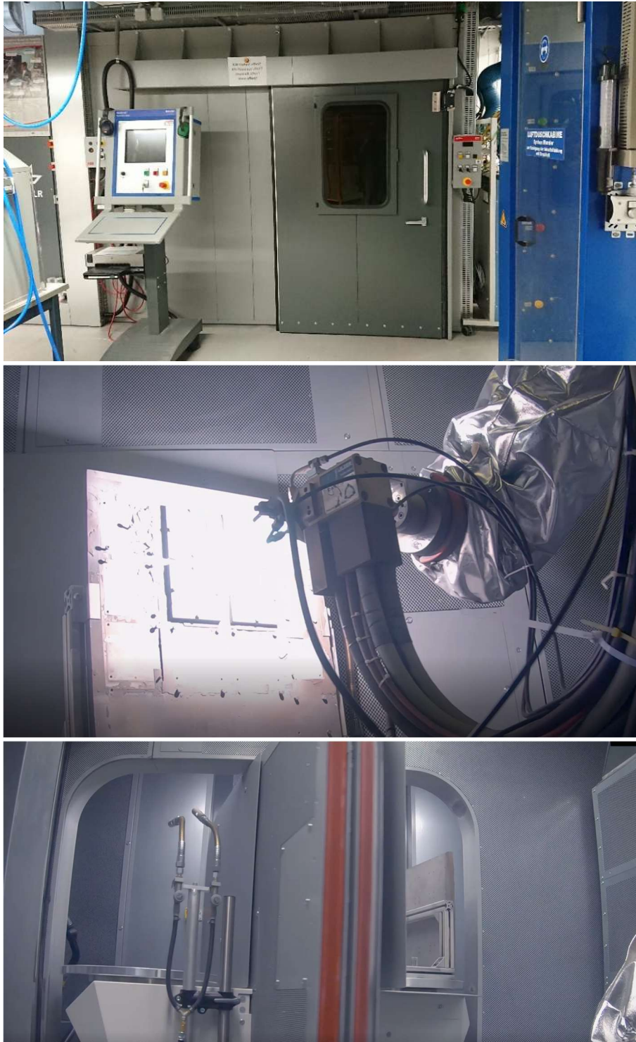
Abbildung 15: APS-Anlage bei DLR. oben: Einhausung der Anlage; Mitte: Plasmabrenner mit Roboterarm und Befestigungswand für Substrate; unten: Schwenkwand für einfachen Wechsel der Substrate
