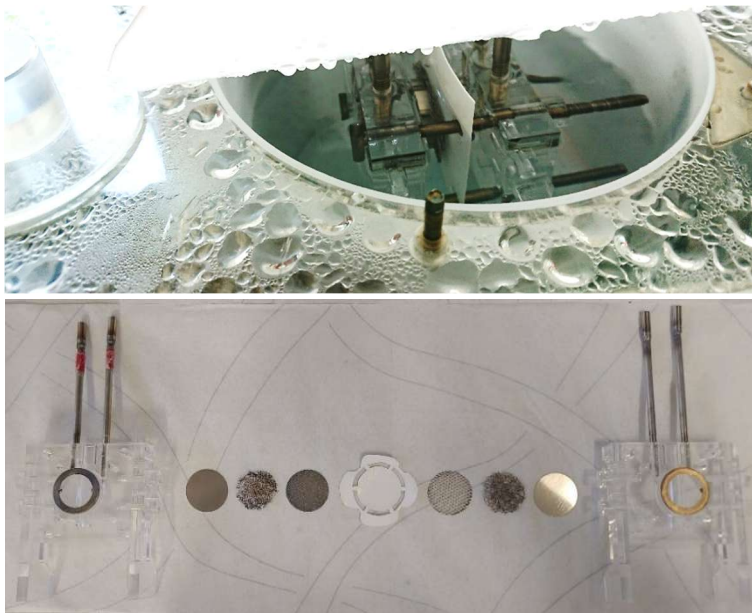
Abbildung 51: Vollzellenanordnung für Tests bei Umgebungsdruck in einer Tauchzelle. Oben; Zelle zusammengebaut im Laugenbad. Unten: Komponenten der Zelle.
