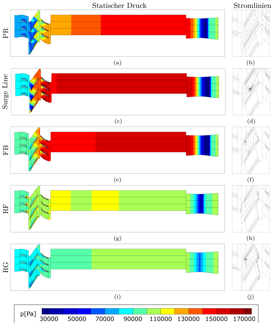
Abbildung 4.3: Statischer Druck und Stromlinien auf 90 % Schaufelhöhe während verschiedener Pumpphasen
