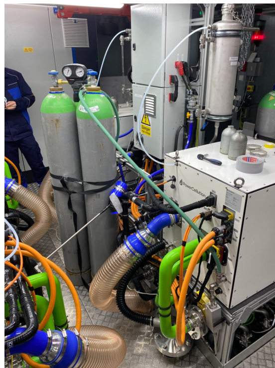
(c) Anschluss der synthetischen Luft aus Druckflaschen an den Anodeneinlass
