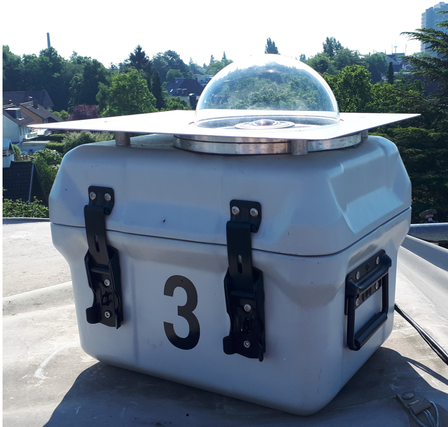
Abbildung 2.10: Hemispherical Sky imager System des Instituts für Meteorologie in Hannover mit integrierter Canon EOS 750D Spiegelreflexkamera
