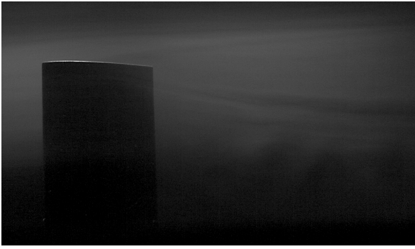
Bild 5: Freie Strömungsvisualisierung um ein NACA 4412-Tragflügelprofil (Anstellwinkel 15^\circ , Re = 45.000 , Strömung von links nach rechts)
