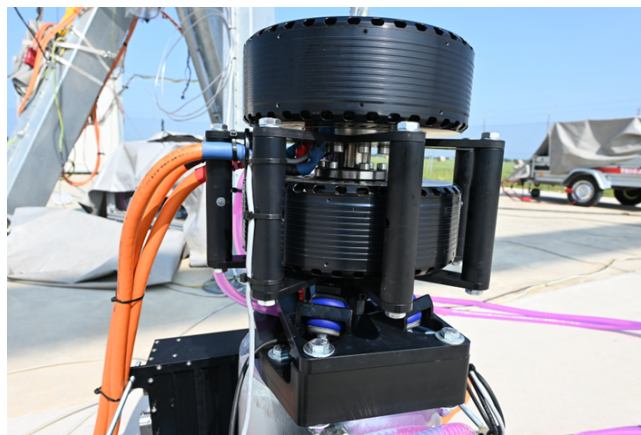
Abbildung 1: Ansicht Antriebsstrang aus zwei gekoppelten Emrax 268 mit Statorkäfig zur Verbindung
