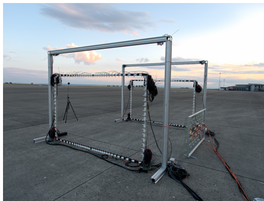
Abbildung 1: Versuchsaufbau auf dem Vorfeld in Cochstedt. Zu sehen sind die zwei mit MEMS Mikrofonen bestückten Tore, das Tracking-Array rechts an der Seite und die Kameras.
