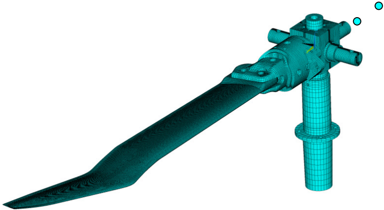
Abbildung 2.7.: Gesamtes Finite-Element-Modell von Rotorkopf und Rotorblatt
