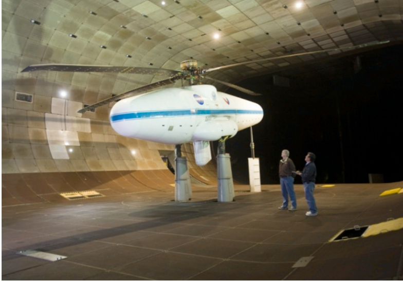
Abbildung 1.6.: UH-60A Airloads Rotor montiert auf dem LRTA im NFAC 40x80 Fuss Windkanal [37]
