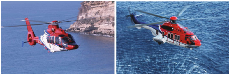
Abbildung 1.1.: Konventionelle Hubschrauber Konfiguration, links: EC155 mit Fenestron als Heckrotor; Rechts: H225 mit normaler Heckrotorbauweise [2]
