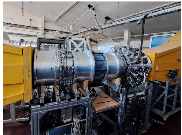
Abbildung 1: Modensynthese-Prüfstand „MOSY“ mit Lautsprecherringen, zwei Mikrofonarrays und reflexionsarmen Abschlüssen (gelb)
