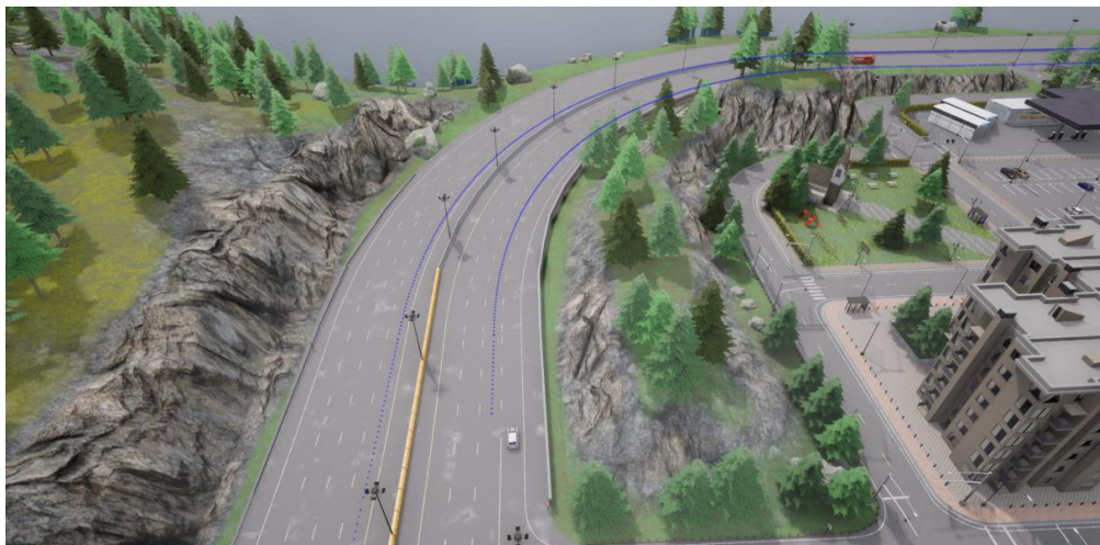
Abbildung 20 Eine Momentaufnahme aus einem Fahrszenario. Hinter der Kurve befindet sich eine Gefahr (stehender Verkehrsteilnehmer), die vom ALKS erst erkannt wird, wenn sie sich in seinem Sensorbereich befindet.
