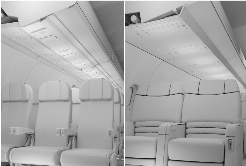
(a) Gepäckablagendesign für Variante 1b-1. (b) Gepäckablagendesign für Variante 1b-2.
