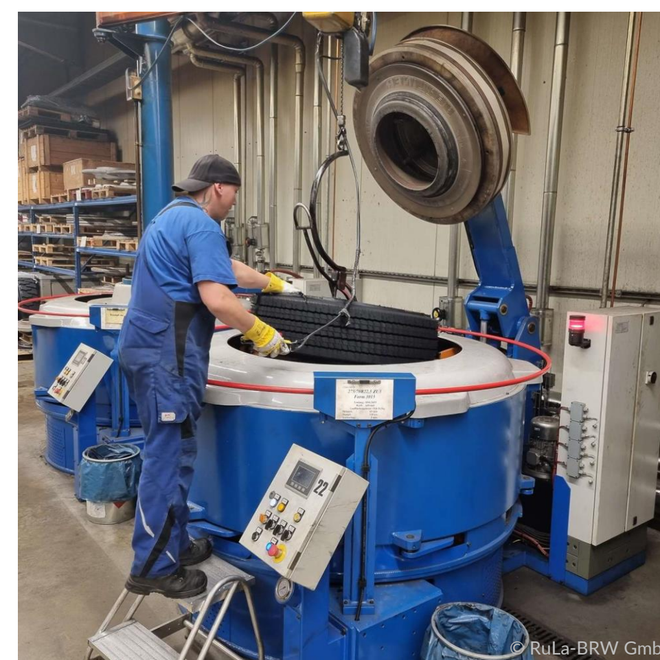
Abb. 2: Vulkanisation von runderneuertem LKW-Reifen bei RuLa-BRW GmbH
