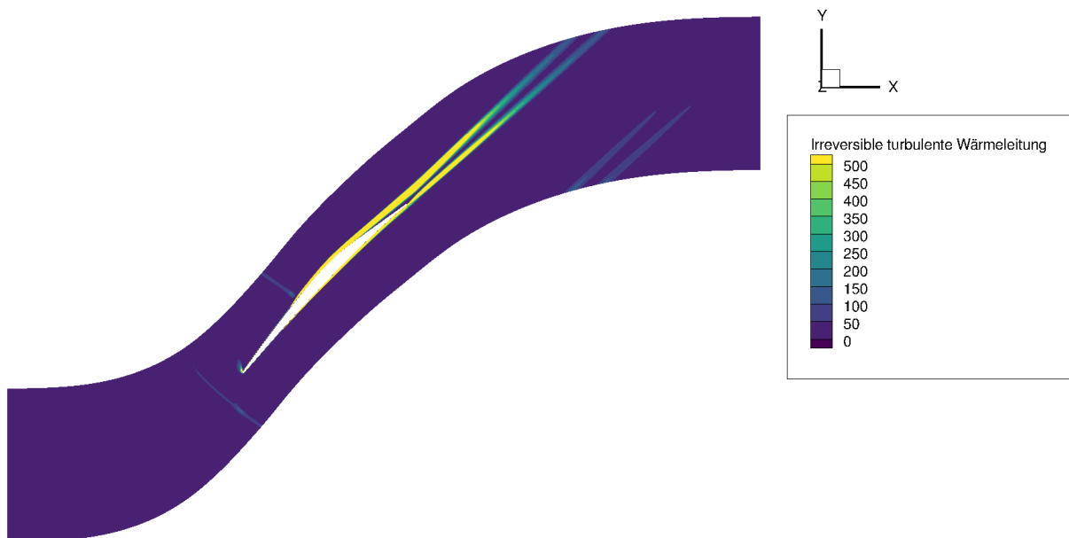
Abbildung 4.5: Lokale Divergenz der turbulenten irreversiblen Wärmeleitung I_t in W/(Km^3)
