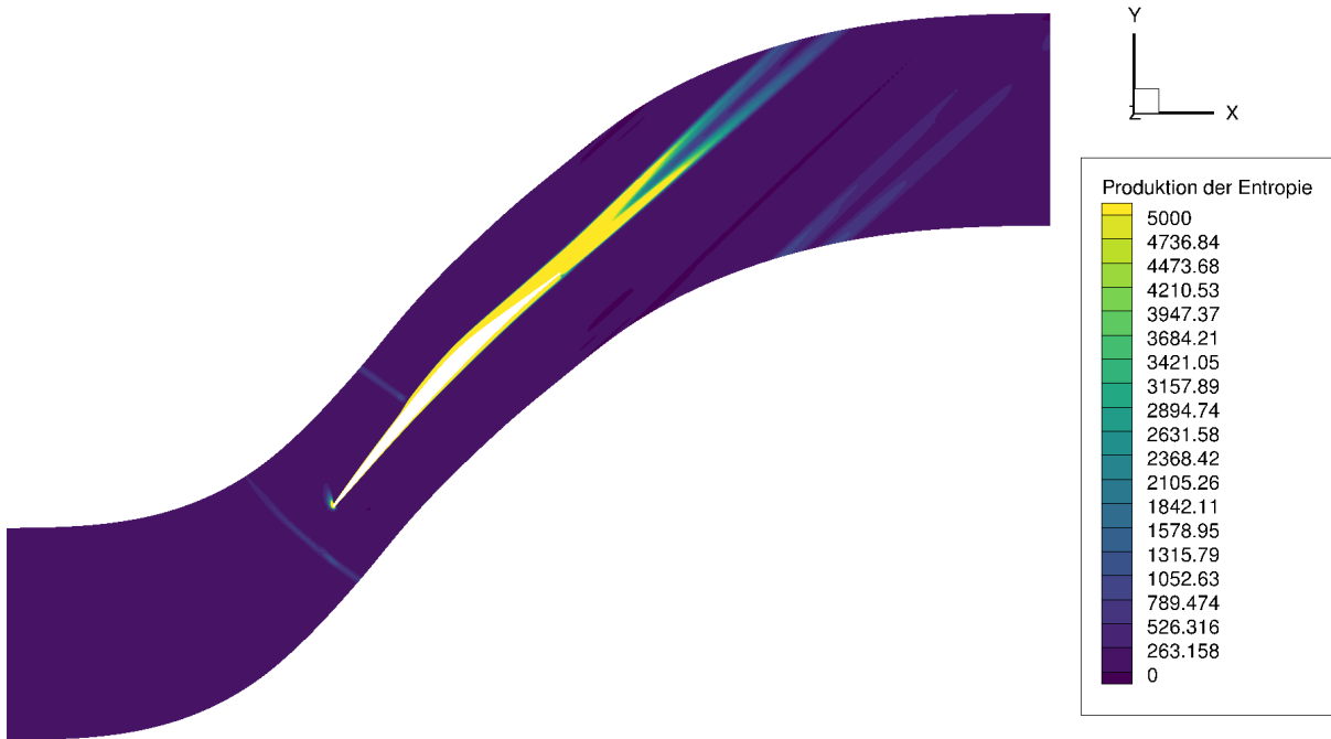
Abbildung 4.1: Volumetrische Entropieproduktion \dot{G}_s in W/(Km^3)
