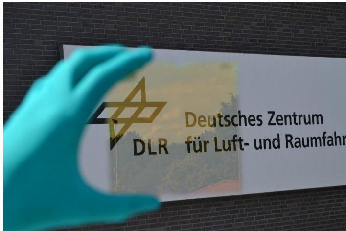
Abbildung 35: Foto des experimentellen Schichtstapels auf einem quadratischem Glassubstrat mit einer Kantenlänge von 10 cm.
