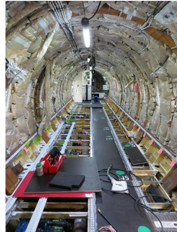
Integration von Sitzschienen zur Aufnahme von Experimenten
