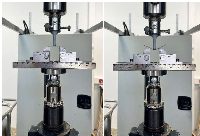
Abbildung 58: Darstellung der Dreipunktbiegeprüfung gemäß DIN EN ISO 14125, links bei Prüfbeginn, rechts bei Prüfende durch Versagen
