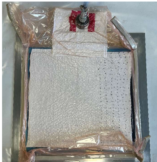
Abbildung 54: Aufbau im „quasi“ Prepregverfahren mit Glasfaser Seartex U-E-1182g/m²-1270mm und GURIT SA-130FR
