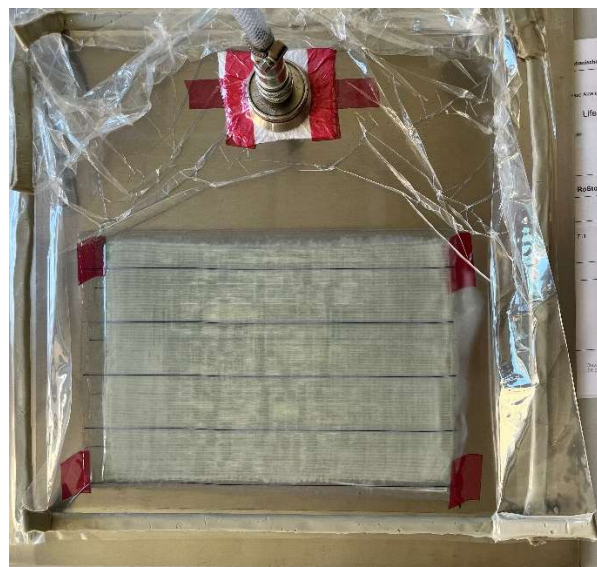
Abbildung 52: Aufbau im Handlaminierverfahren mit Glasfaser Seartex U-E-1182g/m²-1270mm und Sicomini SR FireGreen 37 + SD8202
