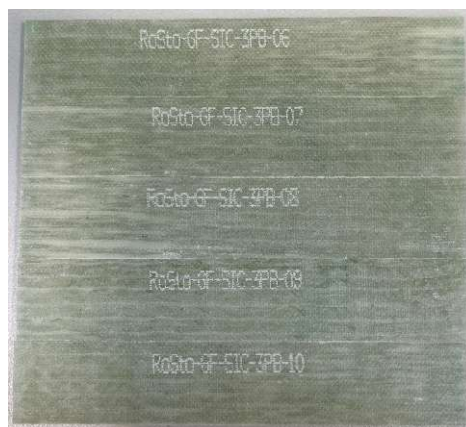
Abbildung 56: Beschriftete Probenkörper nach DIN EN ISO 14125 Klasse III am Beispiel Sicomin Harz mit Glasfaser
