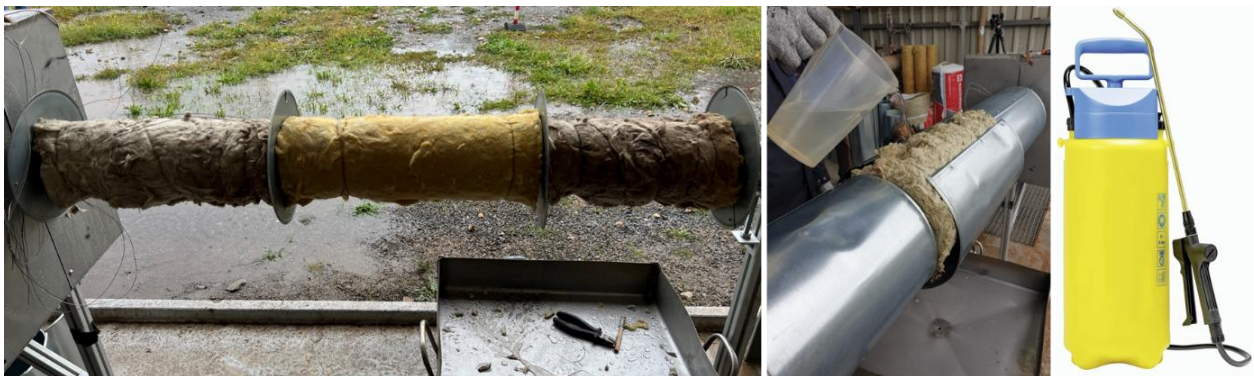
Abbildung 36: Links: drei 50-cm-Abschnitte der Wärmedämmung mit dazwischen liegenden Trennplatten vor der Montage der Dämmstoffdecke und der äußeren Blechabdeckung. Mitte: Aufgießen von HTF auf die Dämmung zur Vorbereitung von Test 1 und 2, rechts: 5-Liter-Druckwassersprüngerät
