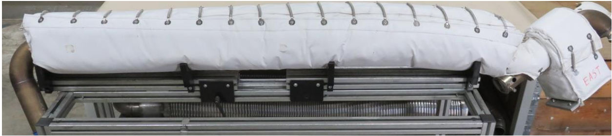
Abbildung 32: REPA-System mit montierter thermischer Isolierung vor dem Einbau in den Senior Flexonics REPA-Teststand
