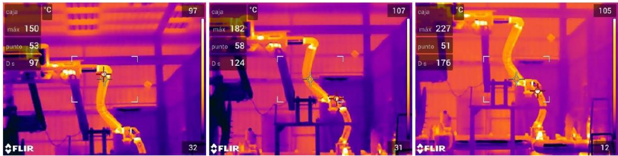
Abbildung 30: IR-Aufnahmen des REPA mit thermischer Isolierung während des Betriebs auf dem Senior Flexonics eigenen Teststand
