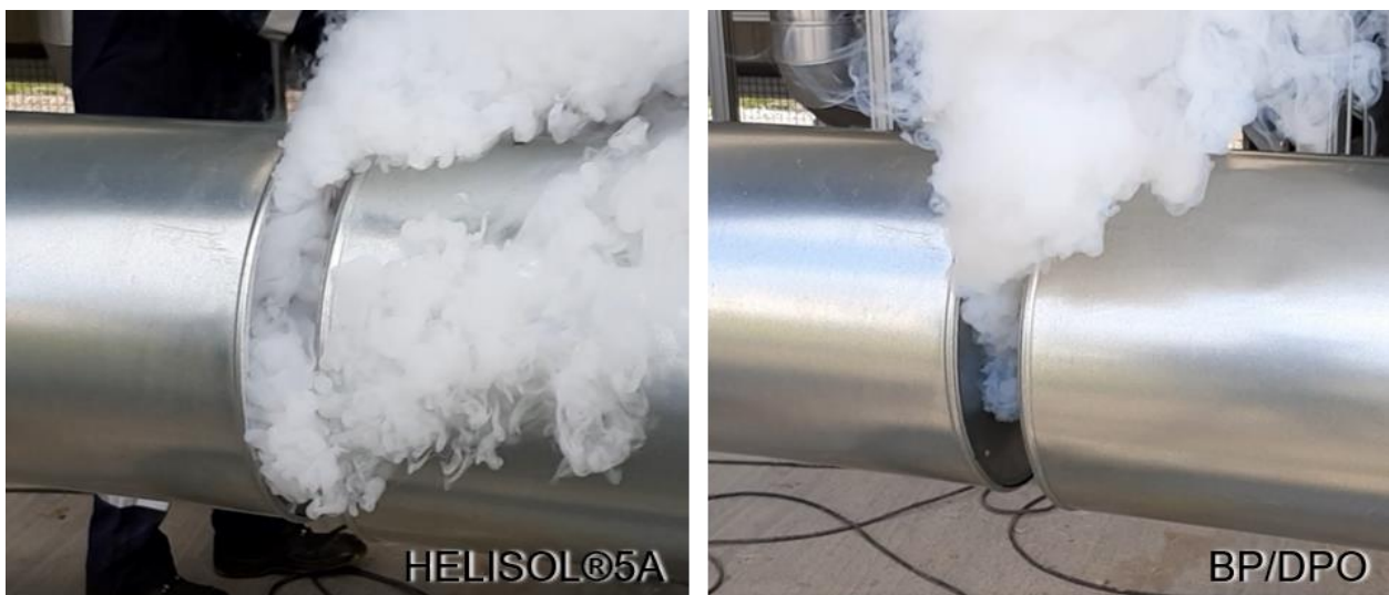
Abbildung 39: Links: HELISOL® 5A-Dampf bei ca. 550 °C, der aus der Kapillare in einem vorgewärmten Isolationsspalt entweicht, rechts: BP/DPO-Dampf bei ca. 550 °C, der aus der Kapillare in einem vorgewärmten Isolationsspalt entweicht
