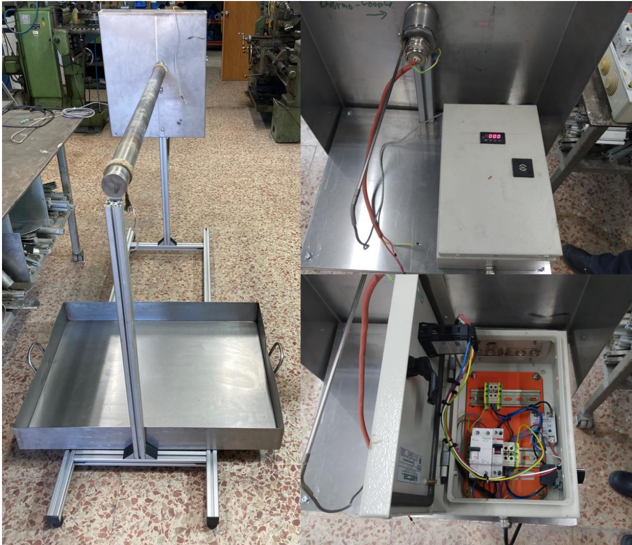
Abbildung 35: links: Testgerät mit innenbeheiztem 2"-Stahlrohr ohne thermische Isolierung, darunter die Auffangwanne; rechts oben: Temperaturregler mit PT100-Sensor und Heizung angeschlossen; rechts unten: neu aufgebauter Schaltkasten mit PID-Temperaturregler und Peripherie.
