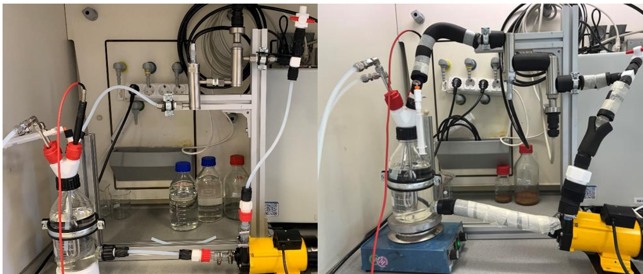
Abbildung 20: Testaufbau beim DLR für flucon-Messsysteme H2Online und Q-Vis, links: erste Version vom 6.2.2023 – Sensoren aufrecht montiert, rechts: letzte Version vom 10.5.2023 – Sensoren kopfstehend, mit thermischer Isolierung
