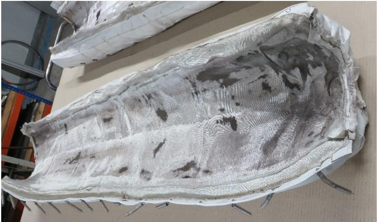
Abbildung 33: Demontierte thermische Isolierung des Wellschlauchs - Innenansicht nach 50.000 Zyklen. Deutlich zu erkennen sind dunkle Stellen an denen Wellschlauch und Isolierung aneinander gerieben haben.
