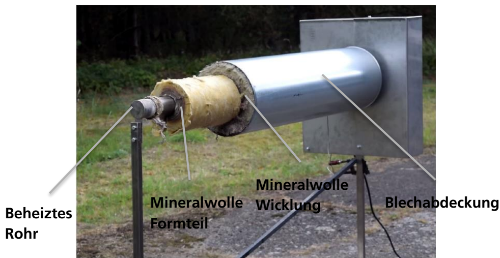
Abbildung 34: Testgerät mit innenbeheiztem 2"-Stahlrohr, zwei Schichten Wärmedämmung und Metalldeckel. Die Temperatur kann mittels eines Temperaturreglers eingestellt werden.
