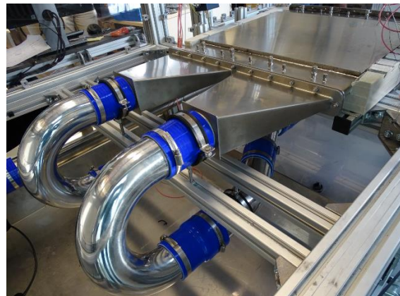
(b) Doppeldiffusor der Luftstrecke mit Anschlussstelle (Flansch) zur Heiz-/Kühlplatte
