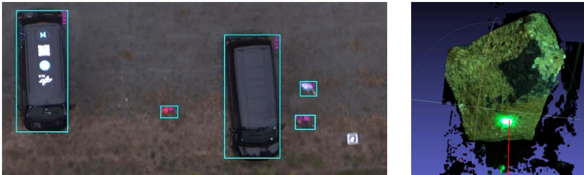
Abbildung 3: Links: KI-gestützte Fahrzeug- und Personenerkennung in der Anwendung UAS-Eye (kombinierte Darstellung). Rechts: 3D-Modell eines Opal-Minerals im Bezugssystem des Spektrometers mit rot eingezeichneter Position des Laserstrahls und seiner tatsächlichen Position als grüner Punkt.
