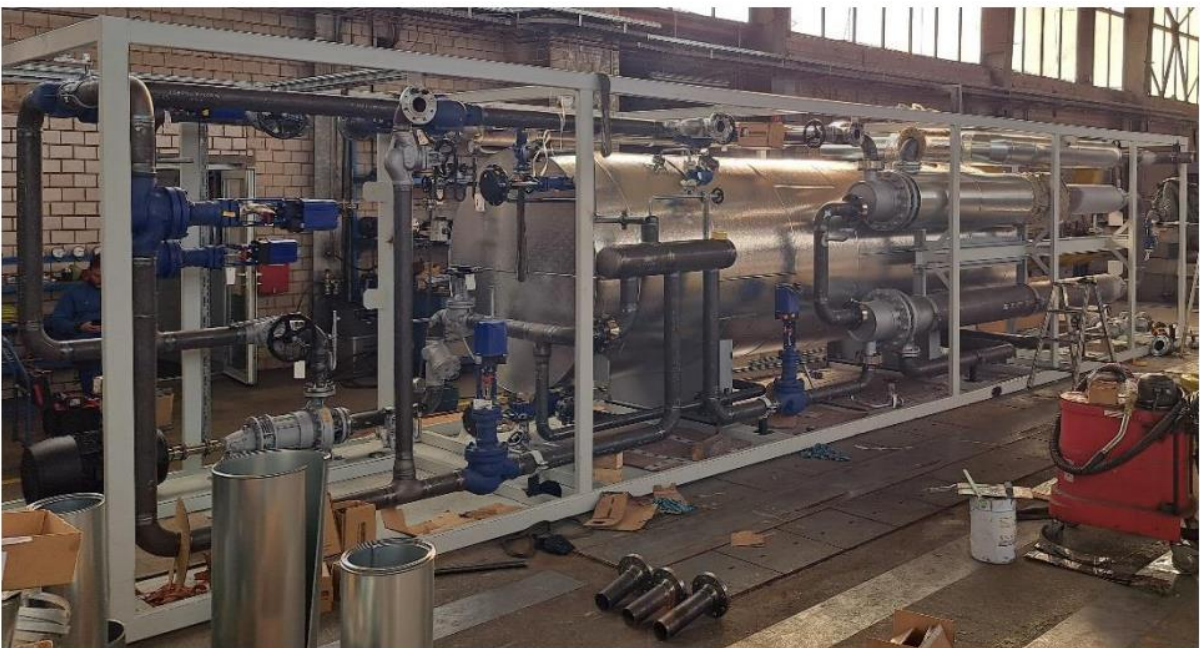
Abbildung 39: selbsttragender Rahmen und BoP
