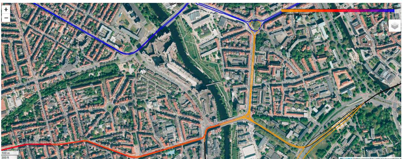
Abb. 3: Beispielergebnis aus OnboardEU. Gezeigt wird die Anzahl von georeferenzierten Überfahrten für Streckenabschnitte im Gleisnetz der Stadtbahn in Hannover. Blaue Gleisabschnitte sind im Rahmen des Projekts mehr als 800-fach befahren worden.
