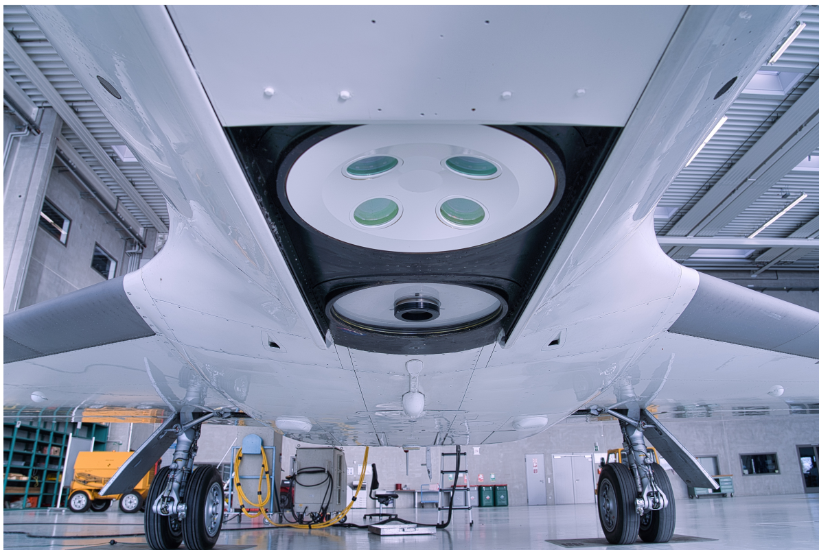
Abbildung 2.6: Außenansicht der im Flugzeugrumpf verbauten Optiken. Die Optiken sind die vier erkennbaren Linsen im Vordergrund [22].
