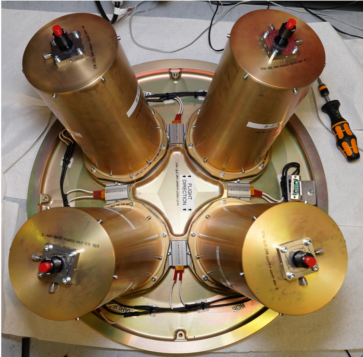
Abbildung 2.7: Montierte Optiken im Labor, die goldfarbenen Tuben ragen später in den Innenraum des Flugzeug. Zwischen den Optiken sind die Heizer angebracht [22].
