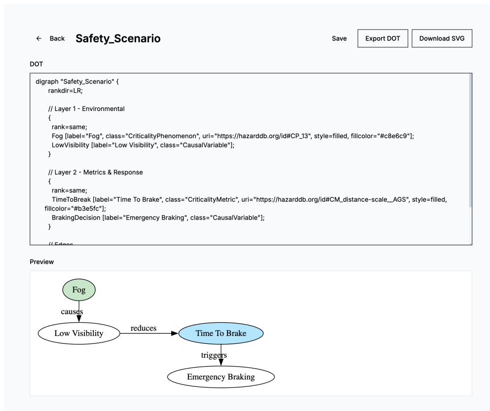
Abbildung 6.13.: Editor-Ansicht zur Erstellung und Bearbeitung von Kausalgraphen. Kausale Ketten werden in Dot-Notation (Graphviz-Sprache) definiert und als gerichtete Graphen mit Knoten (Phänomene, Metriken) und Kanten (kausale Einflüsse) visualisiert.
