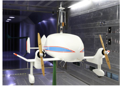
Abbildung 3.3.: ACG2 mit Modifikationen im DNW-LLF
