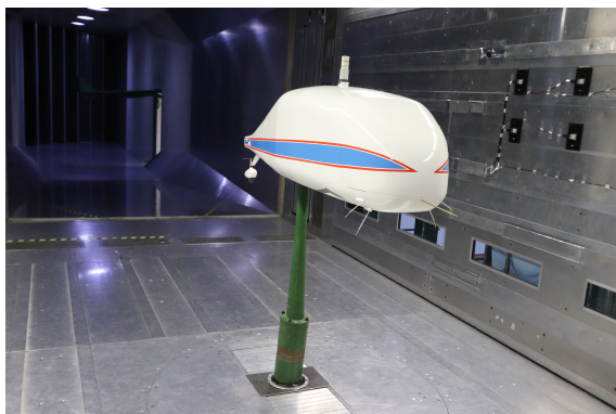
Abbildung 3.5.: Vermessung von Rumpf und verbliebenen Anbauteilen im Windkanal
