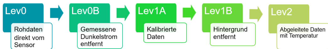
Abbildung 3.1 GRIPS 15 Datenlevel und Verarbeitungsstufen. Von links nach rechts werden die Daten Schritt für Schritt verarbeitet. Von den Rohdaten (Level-0) über die kalibrierten Spektren (Level-1) bis hin zu den abgeleiteten Parametern, wie der Temperatur (Level-2).
