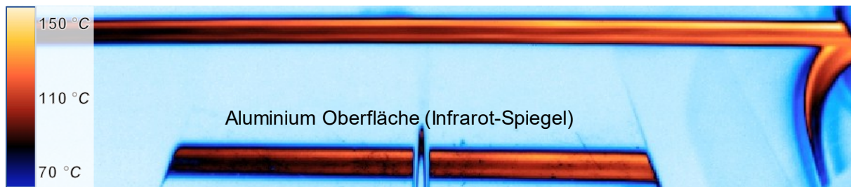
Abb. 4.12: Gleichzeitiges Beobachten von Ober- und Unterseite eines aufgeheizten Halbzeugs
