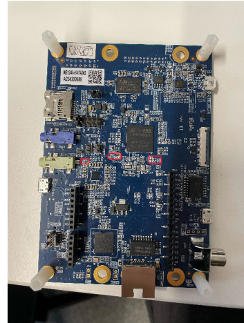
Abbildung 4.1.: STM32-H747-DISCO zu lötende Pins
