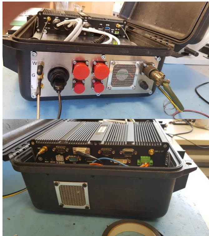
Abbildung 3: Verschiedene Ansichten des Messsystems. Obenauf ist der Industrierechner zu sehen.
