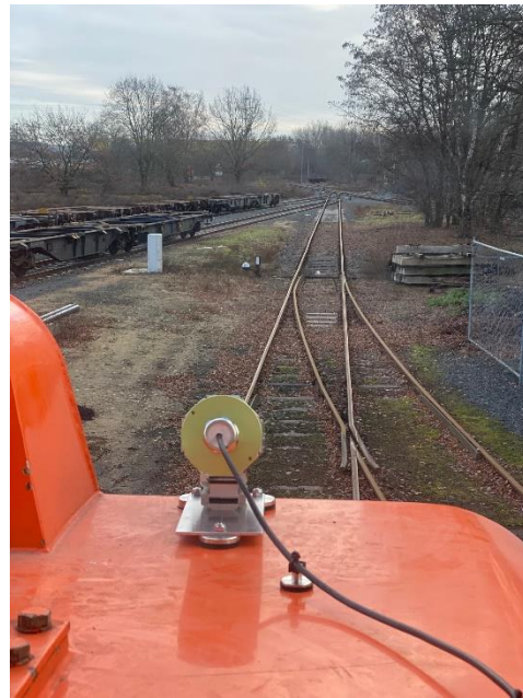
Abbildung 9: Kameragehäuse mit Magnethalterung, Inbetriebnahme auf der Lok
