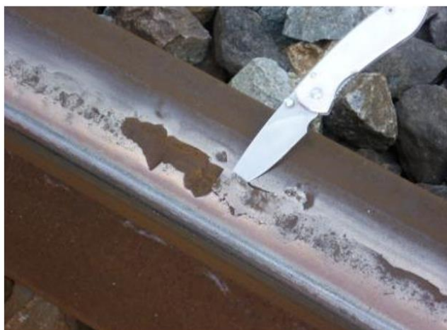
Abbildung 43: Gleisabschnitt mit Ausbruch (Copyright Vossloh)
