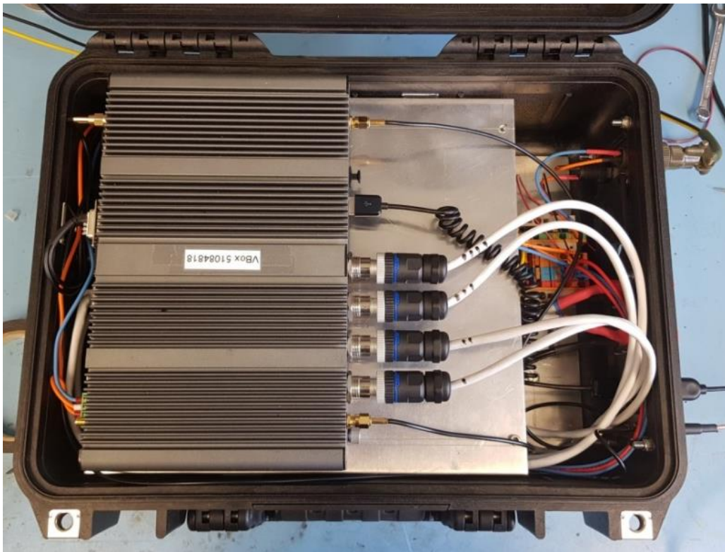
Abbildung 8: Messsystem ohne externe Sensoren im Industriekoffer
