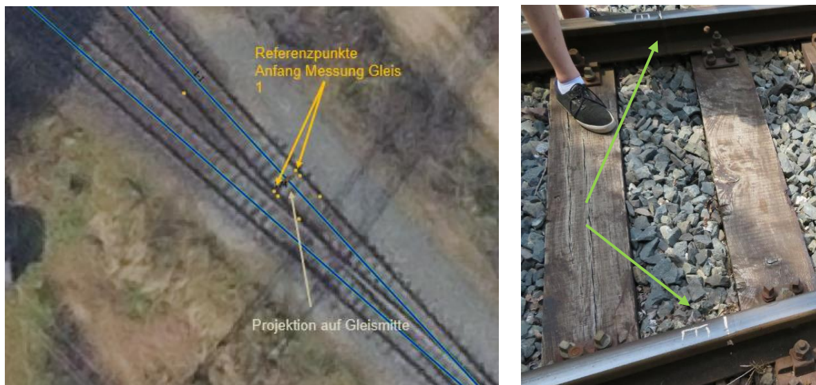
Abbildung 10: Links: Positionen des Messstarts auf Gleis 1 (Referenzdatenerhebung 2020), linke und rechte Schiene (orange); Projektion auf das digitale Gleisnetz (braun). Rechts: Markierungen der Endpunkte der Messungen während der Messkampagne 2020. Luftbildkarte: Stadt Braunschweig, Abteilung Geoinformation.
