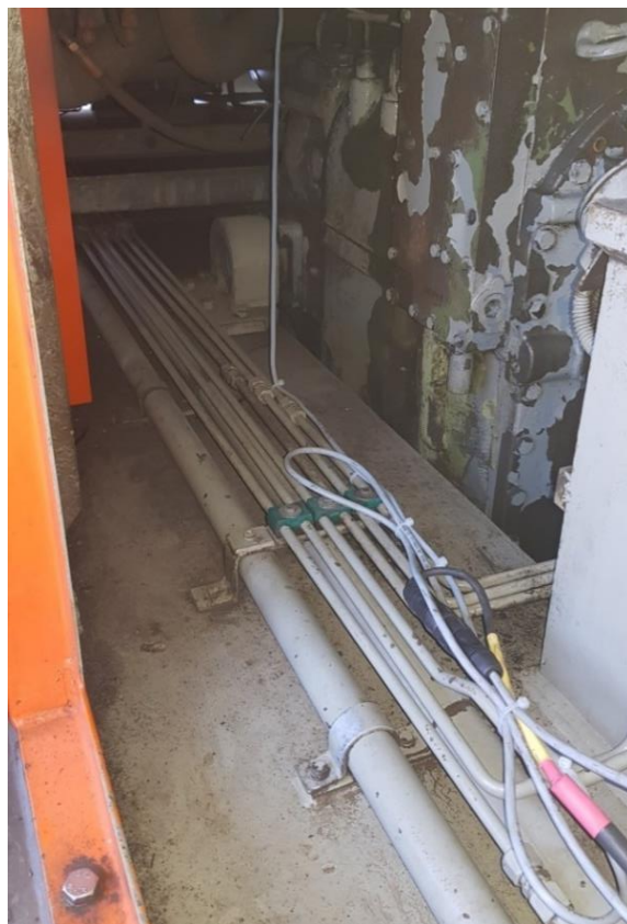
Abbildung 7: Kabellegung im Maschinenraum der Lok
