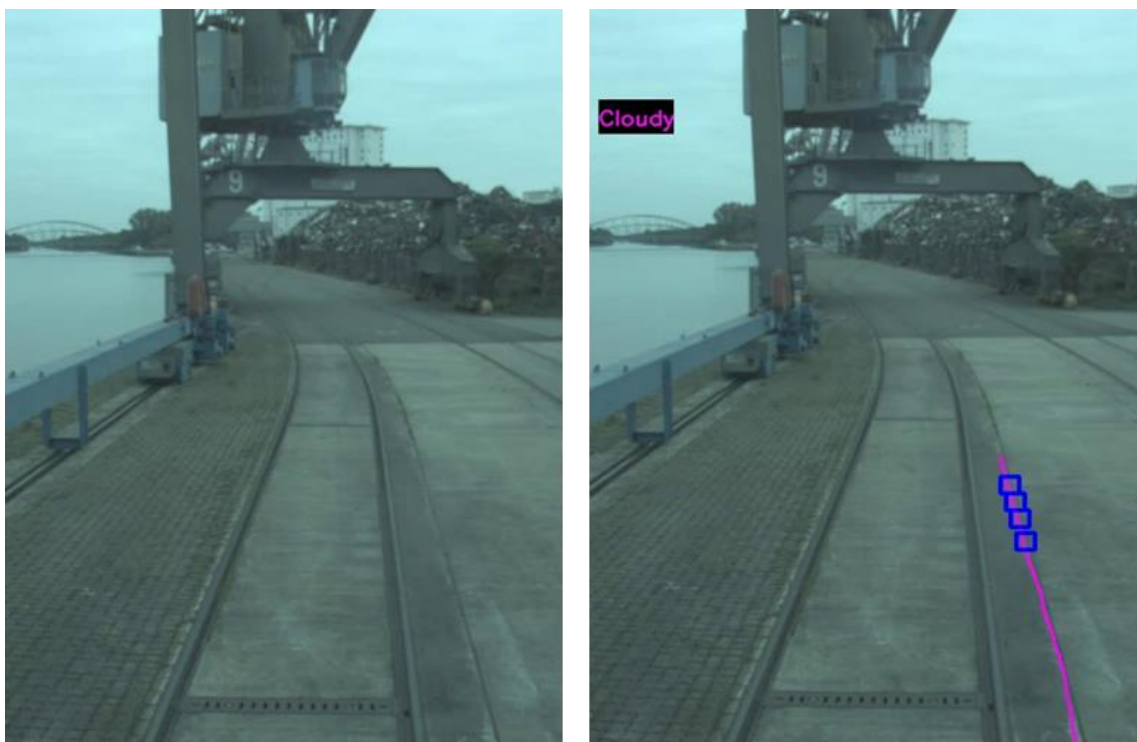
Abbildung 59: Falsch-Positive Erkennung auf Gleis 7 auf den eingebetteten Schienen
