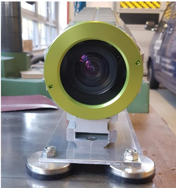
Abbildung 9: Kameragehäuse mit Magnethalterung, Inbetriebnahme auf der Lok
