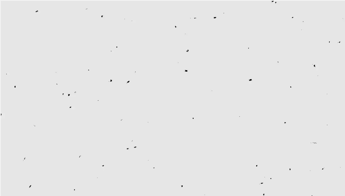
Geringe Tracerdichte (ca. 2 MB/s)
