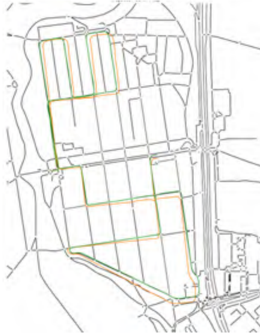
Abbildung 79: Driftende LiDAR-Odometrie (orange) und genaue Schätzung durch Integration der Kartendaten (grün).
