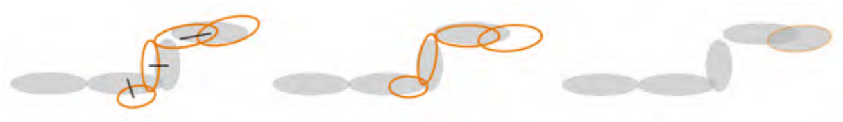
Abbildung 77: Schematisches Registrieren zwischen Karte (grau) und neuem Scan (orange).
