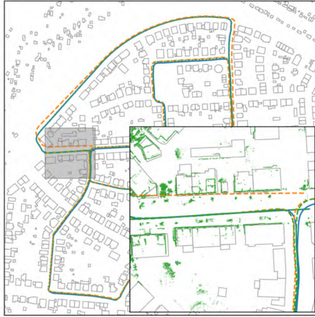
Abbildung 81: Visualisierung der geschätzten Trajektorie und der lokalen Karte (grün) auf dem KITTI [43] Datensatz. Der Drift der Lidar-Odometrie (orange) konnte mithilfe der Kartendaten von OpenStreetMap [52] (grau) verhindert werden.
