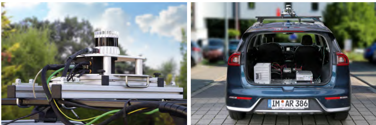
Abbildung 6: Im Projekt aufgebaute Sensorplattform, inkl Referenzlokalisierung zur Datenaquisition und autarken Navigation mit Hochleistungs-Fahrzeugrechner
