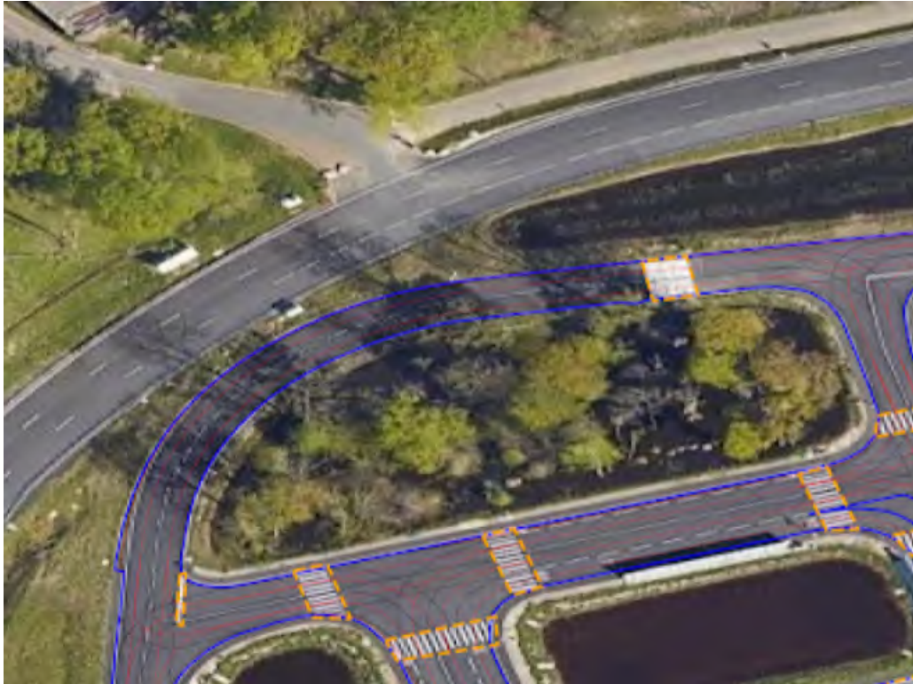
Abbildung 32: Ansicht des generierten Mapping-Tools. Ein Satellitenbild ist mit Karteninformationen überlagert. Spurbegrenzungen und Pfade sind als semitransparente rote und grüne Linien dargestellt. Des Weiteren werden die extrahierten Begrenzungen der befahrbaren Flächen als blaue Linien eingetragen.
