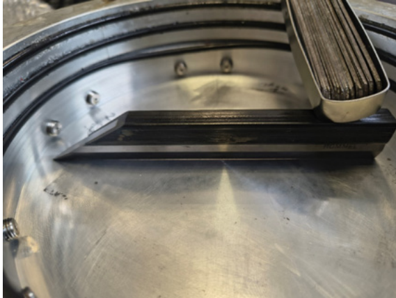
Abb. 14: Nach Demontage des Klöpperbodens wurde eine Wölbung der kalten Schale festgestellt.
