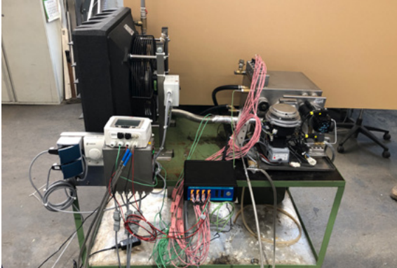
Abb. 11: Laborversuchsstand ThermoMarE mit Heizgerät (rechts), Wärmetauscher zur Abgabe der Wärme an die Umgebung (links) sowie Steuerungs- und Messtechnik.
