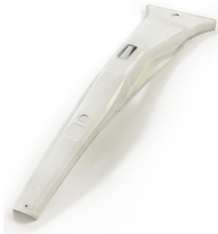
Abbildung 9: Prototypische B-Säulenverstärkung eines Golf V [10]
