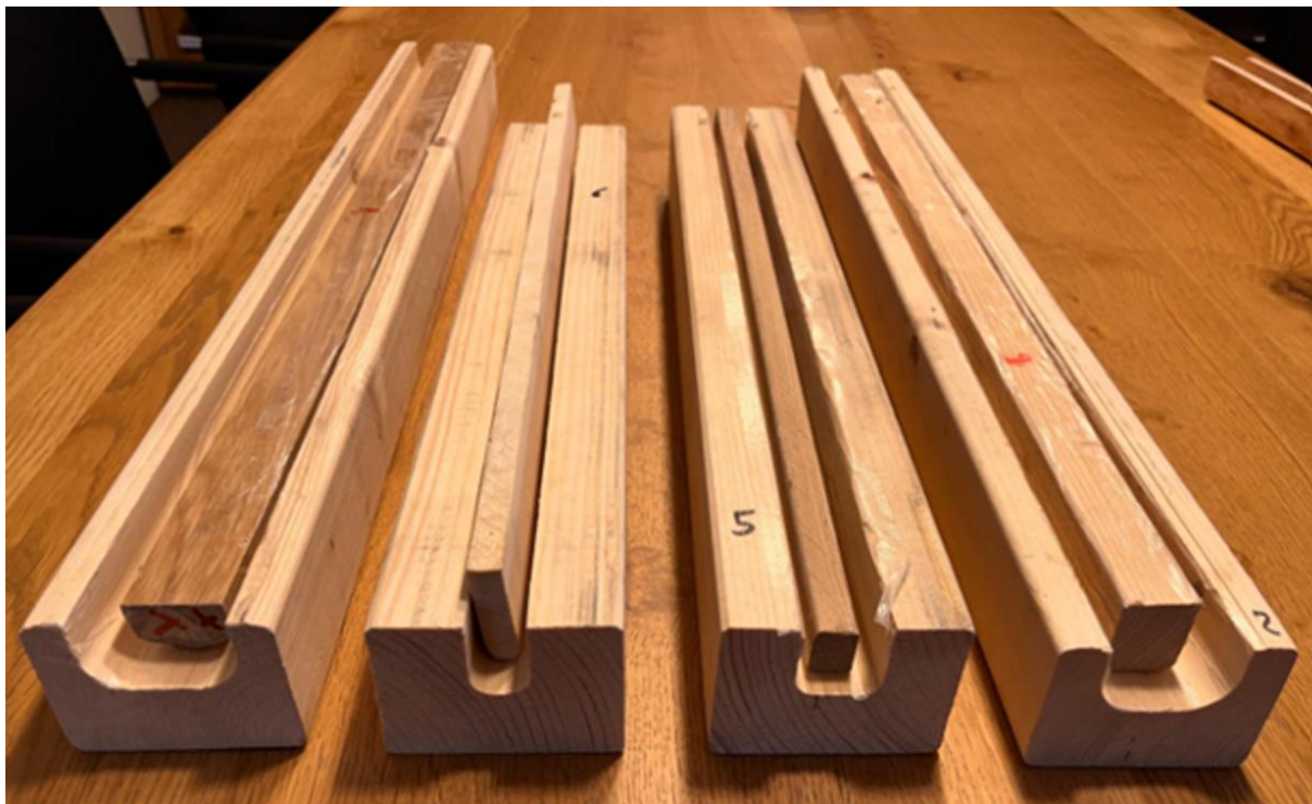
Abbildung 12: Presswerkzeuge in verschiedenen Radien
