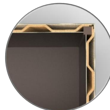
c) Konzept der Seitenwand mit Formholzteilen
