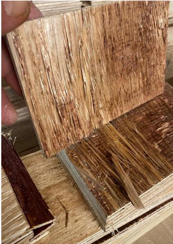
Abbildung 17: links: Ergebnis durch Wash-Out ; rechts: Leimspalter
