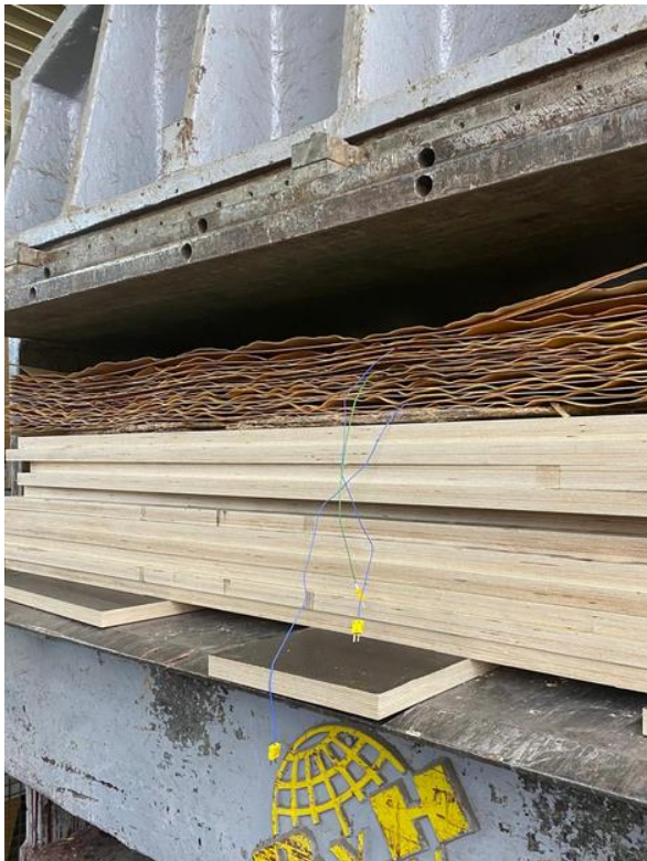
Abbildung 18: links: Pressvorgang mit Phenolharzleim und Temperaturüberwachung im Kern der Platte um 90°C nicht zu übersteigen; rechts: Ergebnis der fertigen Platte Albasia d+d ohne Spalter und ohne Wash-Out
