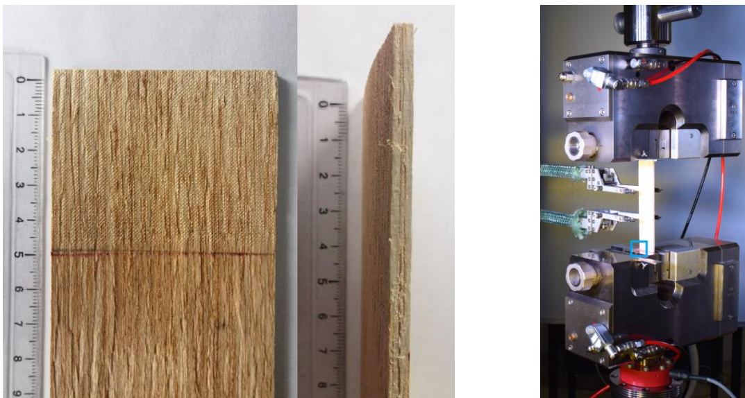
Abbildung 59: Probengeometrie und Versuchsvorrichtung für die Charakterisierung von Einzelfurnier unter Zugbelastung, aus [10].
