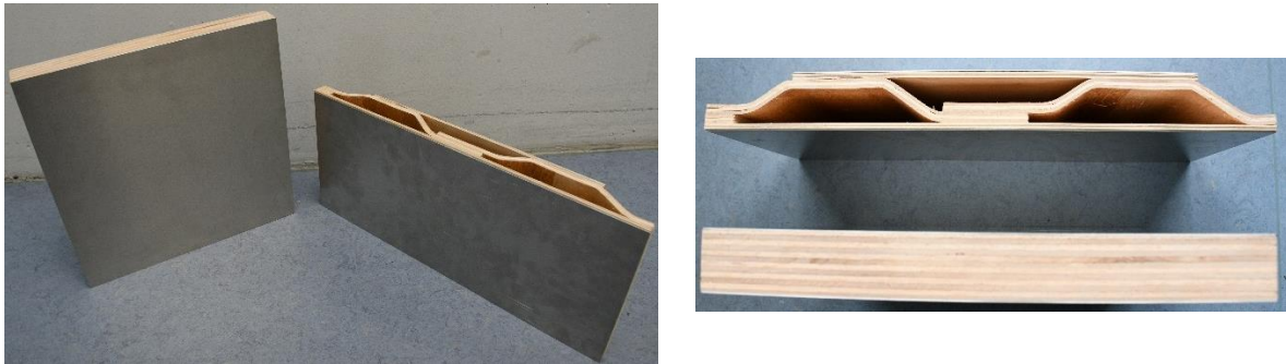
Abbildung 55: Proben für die Bestimmung der Wärmeleiteigenschaften von Albasia-Hybridmaterialien. Sperrholzplatte und Ausschnitt aus dem Wandsegment mit Albasia-Formholz-Kern
