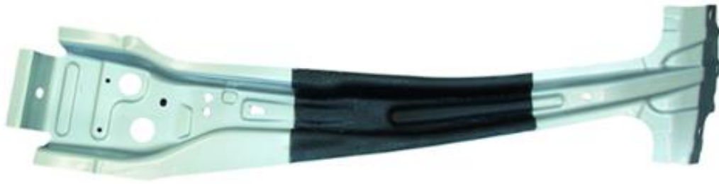
Abbildung 8: Lokal mit FVK verstärkte B-Säule [9]
