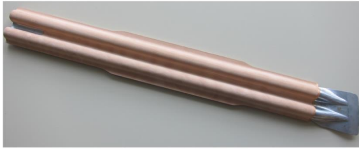
Abbildung 3: Erster Demonstrator Projekt HAMMER: Seitenverstärkungsstrebe eines Serien-PKW [1]
