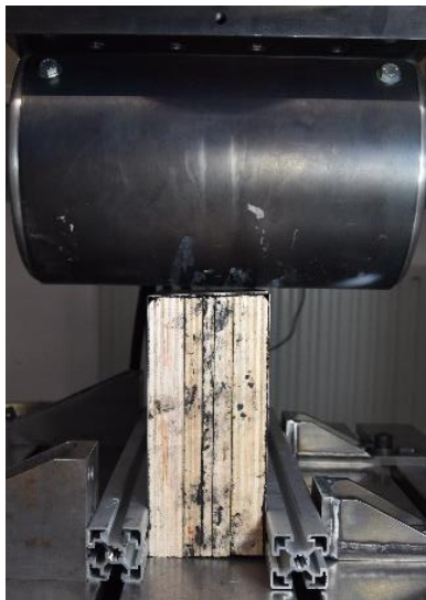
Abbildung 47: Stauchversagen der hybriden Albasia-Sperrholzprobe mit 100 mm Plattenstärke Versuchsaufbau (links). Querschnitt der Probe nach dem Test zeigt die starke Verformung und Verdichtung des Albasia Holzkerns (rechts)
