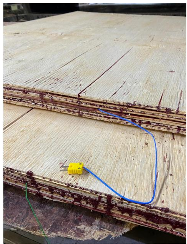
Abbildung 18: links: Pressvorgang mit Phenolharzleim und Temperaturüberwachung im Kern der Platte um 90°C nicht zu übersteigen; rechts: Ergebnis der fertigen Platte Albasia d+d ohne Spalter und ohne Wash-Out
