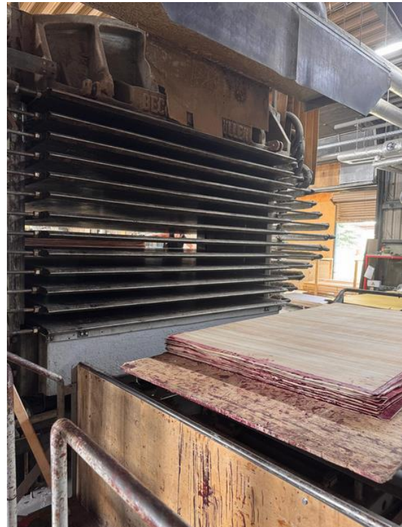
Abbildung 16: links: Laumauftrag auf Furniere in der Industrieproduktion ; rechts: Etagenpresse mit Heizplatten
