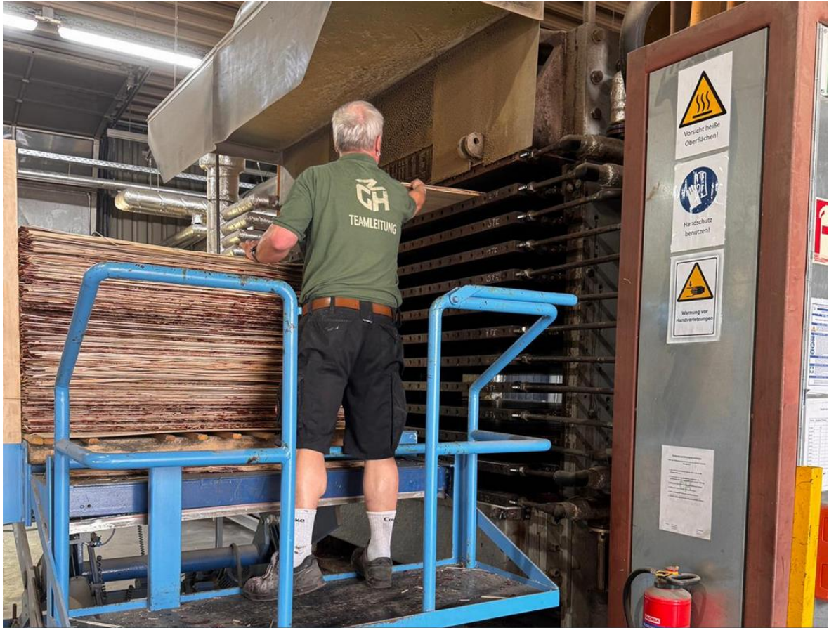
Abbildung 20: Etagenpresse mit beheizten Pressblechen zur Verarbeitung von Phenolharz
