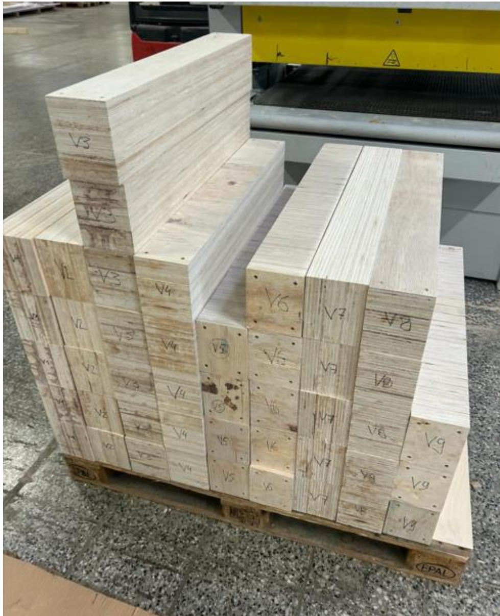
Abbildung 26: Schwellerblöcke mit verschiedenen Furnieraufbauten und Furnierlagen innerhalb des Schwellers.
