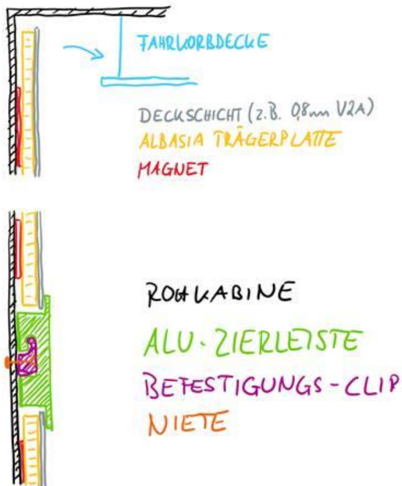
Abbildung 1: Skizze Wandaufbau Fall 1
