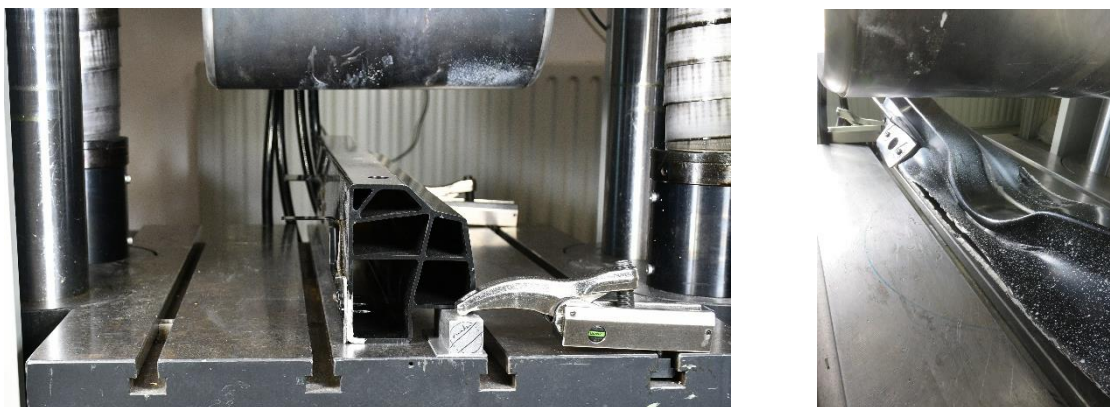
Abbildung 102: Versuchsaufbau der quasi-statischen Pfahltests am Referenzschwellereinleger (links). Aufnahme nach dem Test (rechts).
