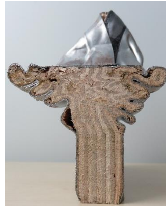
Abbildung 46: Stauchversagen der hybriden Albasia-Sperrholzprobe mit 30 mm Plattenstärke beplankt mit Stahlblech (links). Querschnitt der Probe nach dem Test zeigt die starke Verformung und Verdichtung des Albasia Holzkerns (rechts)
