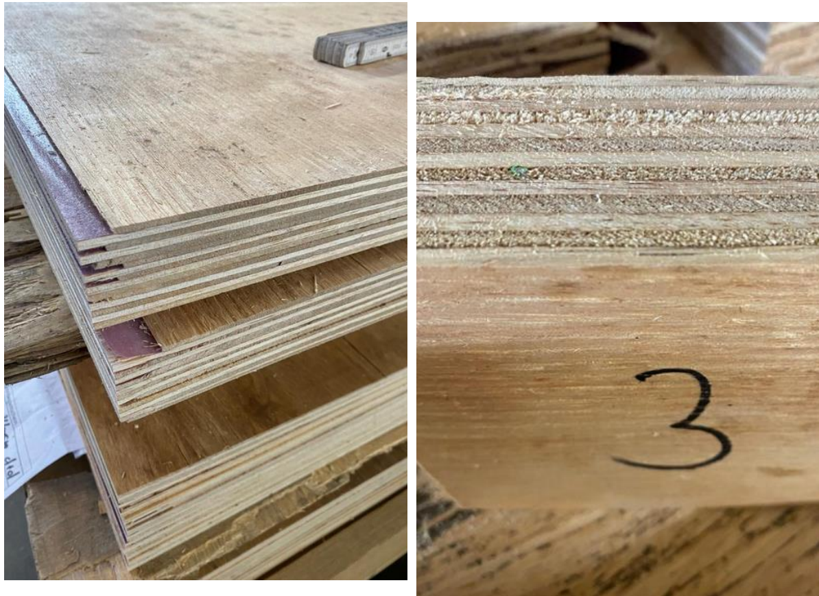
Abbildung 19: links Albasia d+d Sperrholzplatte mit Leimfilm verarbeitet eine Kante besäumt, eine Kante roh; rechts Albasia d+d Sperrholzplatte mit Leimfilm verarbeitet besäumte Sägekante, (offenporige, fasrige Kante deutlich zu sehen)
