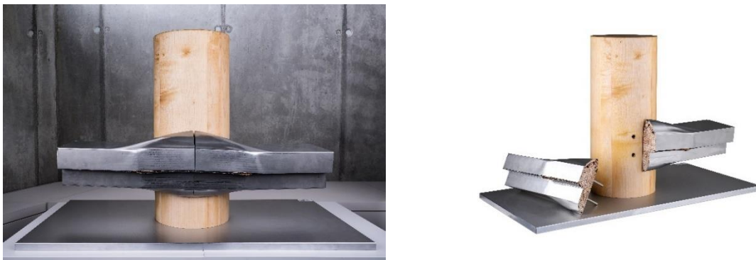
Abbildung 106: Demonstrator des Hybriden Schwellereinlegers. Symbolisiert wird der Aufprall gegen Pfahl. Abbildung rechts zeigt den aufgesägten Schweller zur Darstellung der Verdichtung des Holzkerns.
