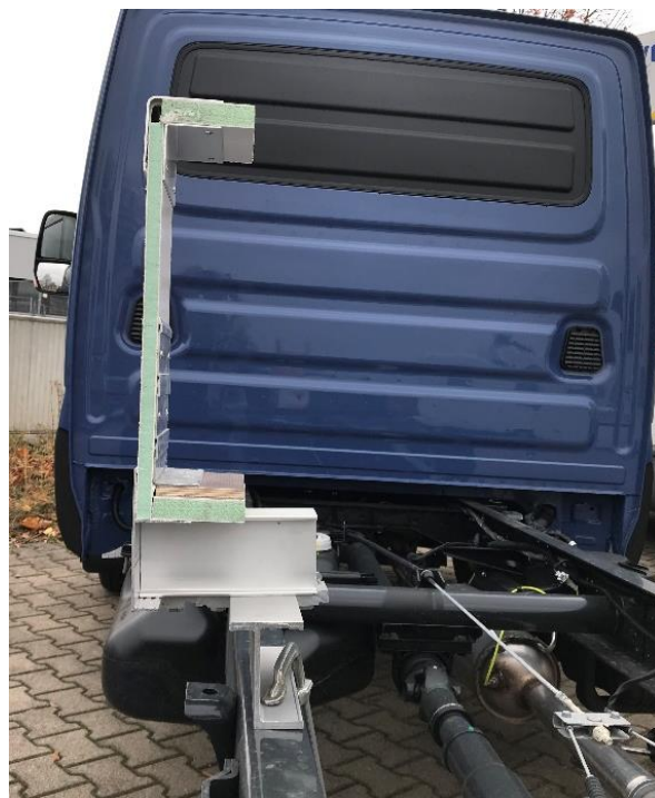
Abbildung 12: Querschnitt eines Nutzfahrzeugaufbaus in Sandwichbauweise
