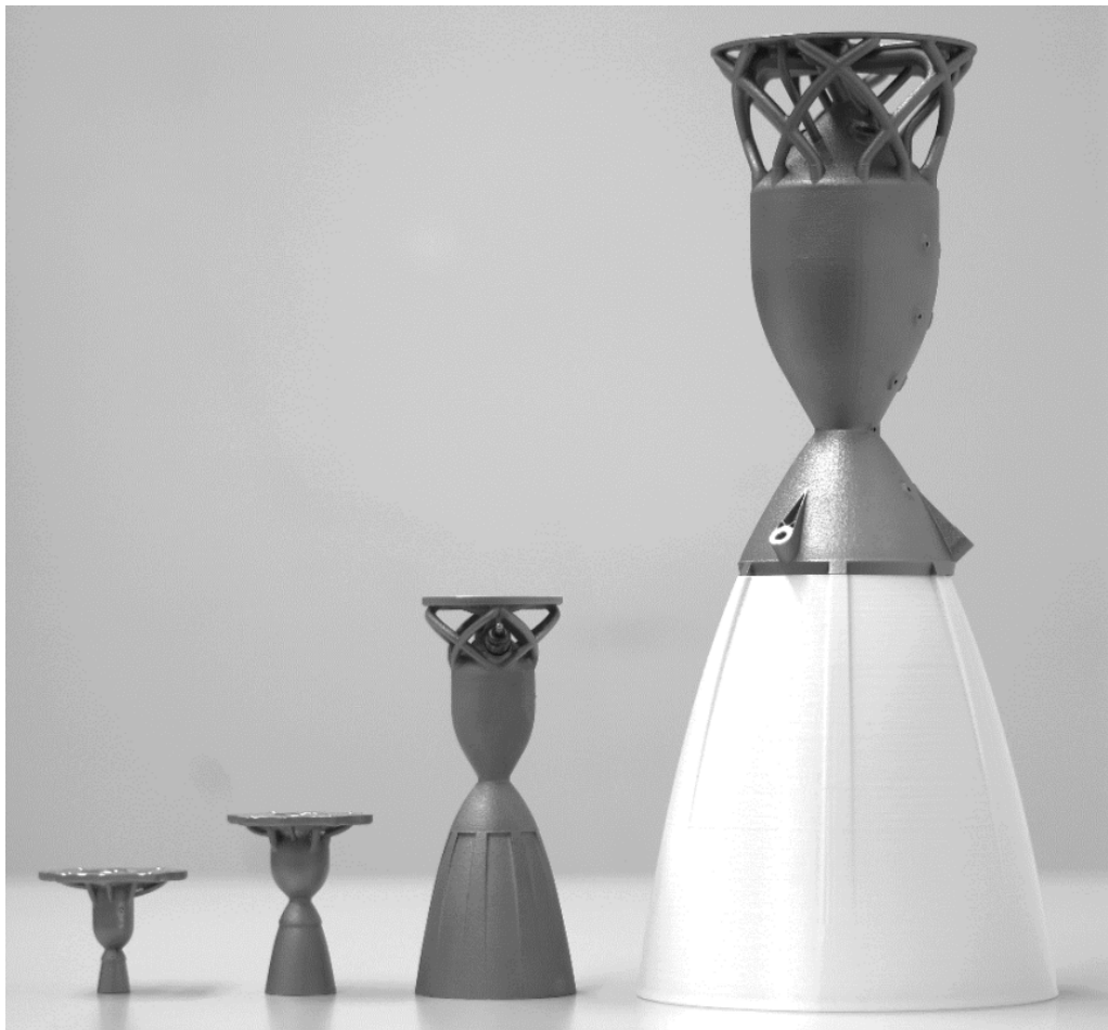
Bild 3.2: HyNOx-Thruster von INSPACEPROPULSION TECHNOLOGIES GMBH. Von Links: IDENO-1 (1 N-Thruster), IDENO-5 (5 N-Thruster), IDENO-22 (22 N-Thruster), IDENO-200 (200 N-Thruster) mit Düsenerweiterung [52].
