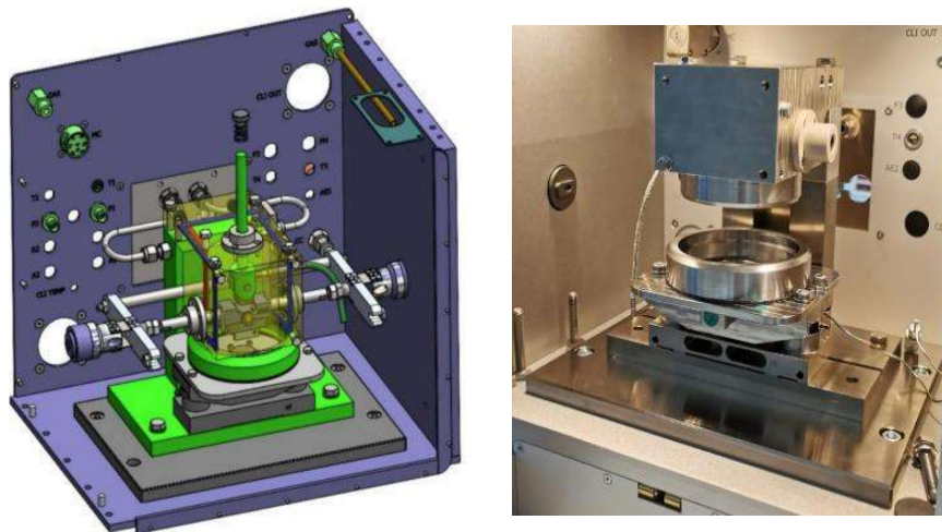
Bild 4: CAD der gasbeschickten Kammer mit einem Innenvolumen von ca. 0,3 l (gelb) für den SRV®5-Prüfstand (links) und Teilaufbau der Kammer während Abnahme beim Hersteller Optimol Instruments GmbH (rechts)
