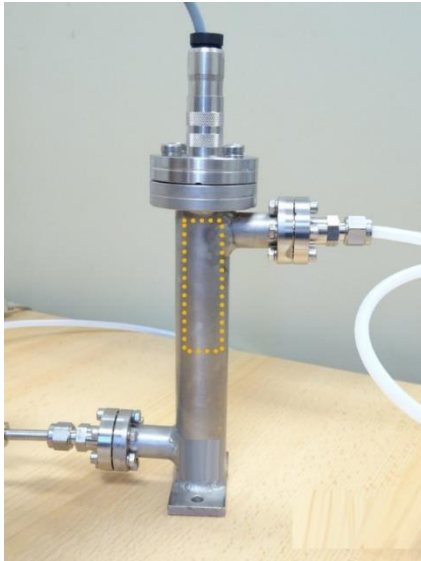
Abbildung 1: Messzelle mit 6 mm Gasanschlüssen, CF-Flanschen mit gasdichter Kontaktierung, der orange-gepunktete Rahmen stellt die Sensorposition innerhalb der Messzelle dar.
