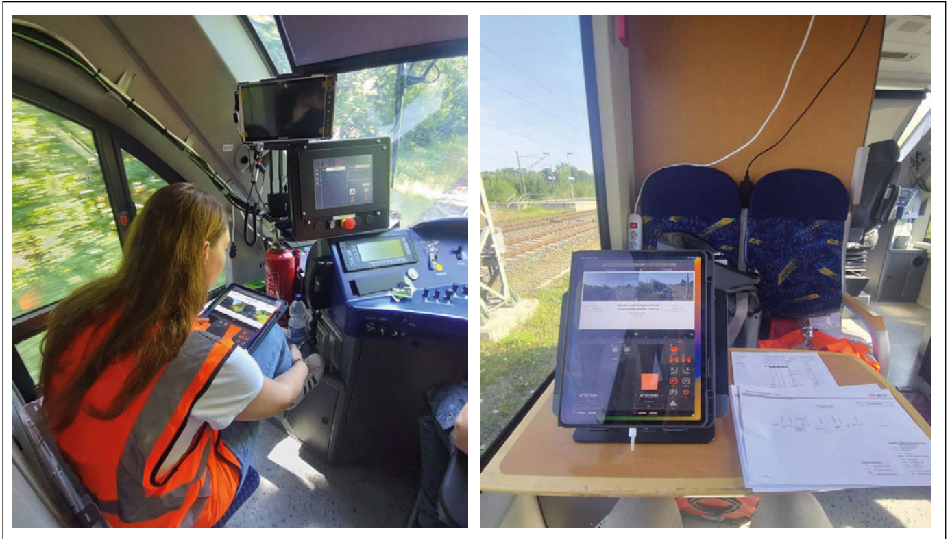
Bild 4: RTO-Probantentests mit Tablet-Steuerung: links im Führerstand, rechts im Fahrgastraum
