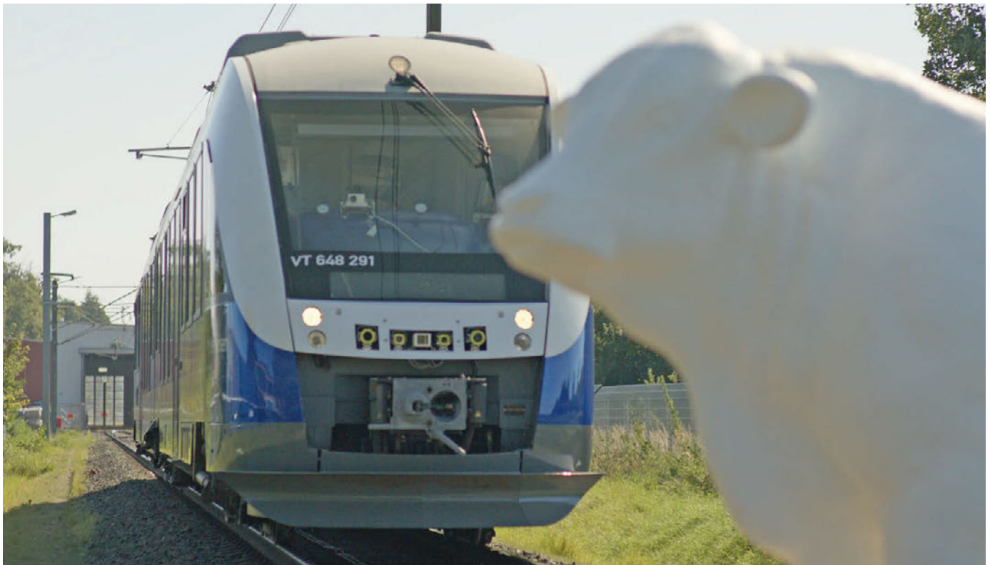
Bild 2: Erprobung der Hinderniserkennung auf dem Testgleis
