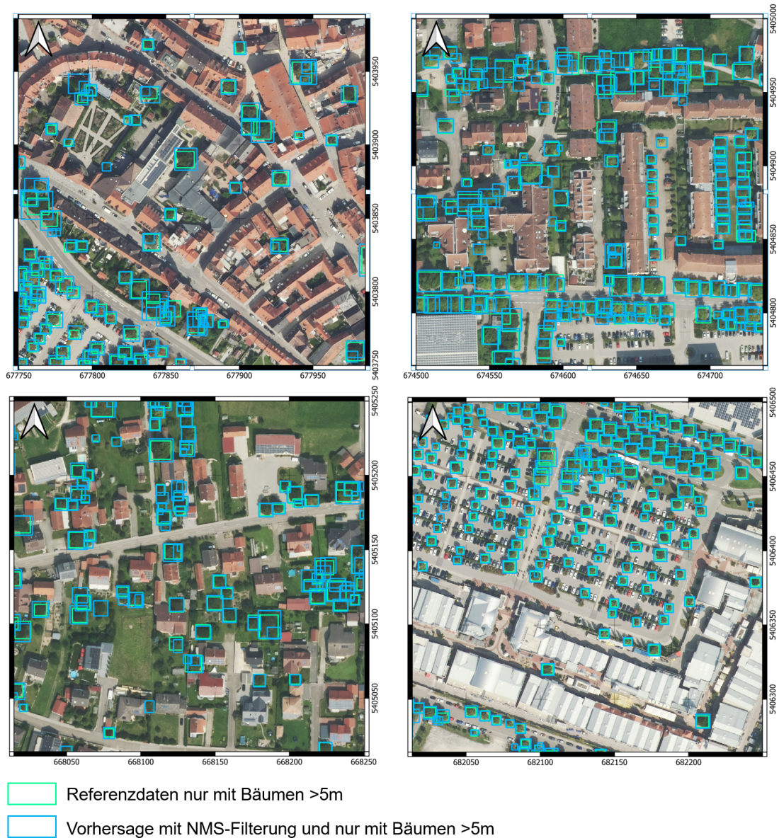
Abbildung 4.26: Überlagerung der nach Höhe (> 5 m) gefilterten Referenzen (türkis) und der mit NMS sowie nach Höhe (> 5 m) gefilterten Vorhersagen (blau) aus Ingolstadt. Oben links: Kategorie 1, oben rechts: Kategorie 2, unten links: Kategorie 3, unten rechts: Kategorie 4. Quelle des Orthophotos: LDBV (2025e).
