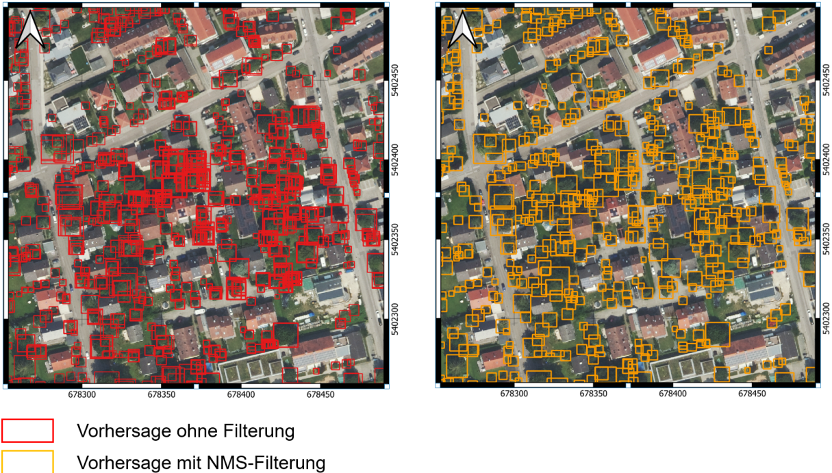
Abbildung 4.22: Gegenüberstellung von ungefilterten Vorhersageergebnissen (links) und mit NMS gefilterten Vorhersagen (rechts) aus Ingolstadt, Kategorie 3. Quelle des Orthophotos: LDBV (2025e).
