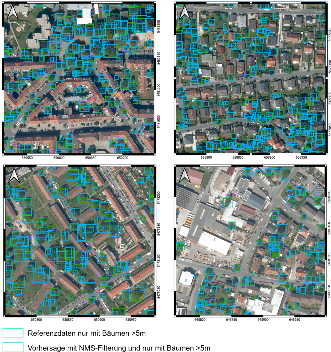
Abbildung 4.25: Überlagerung der nach Höhe ( > 5 m) gefilterten Referenzen (türkis) und der mit NMS sowie nach Höhe ( > 5 m) gefilterten Vorhersagen (blau) aus Nürnberg. Oben links: Kategorie 1, oben rechts: Kategorie 2, unten links: Kategorie 3, unten rechts: Kategorie 4. Quelle des Orthophotos: LDBV (2025e).
