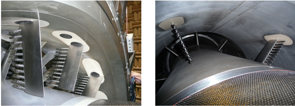
Abbildung 5.1: Das linke Foto zeigt die am Fan-Prüfstand UFFA verwendeten Mikrofonrechen stromab des Fanleitrads [134]. Das rechte Foto zeigt die gleichen Mikrofonrechen in der Installation als Array RMD2 sowie die linienförmig angeordneten Einbaupositionen des alternativen wandbündigen axialen Arrays RMD3 in der Austrittssekktion.
