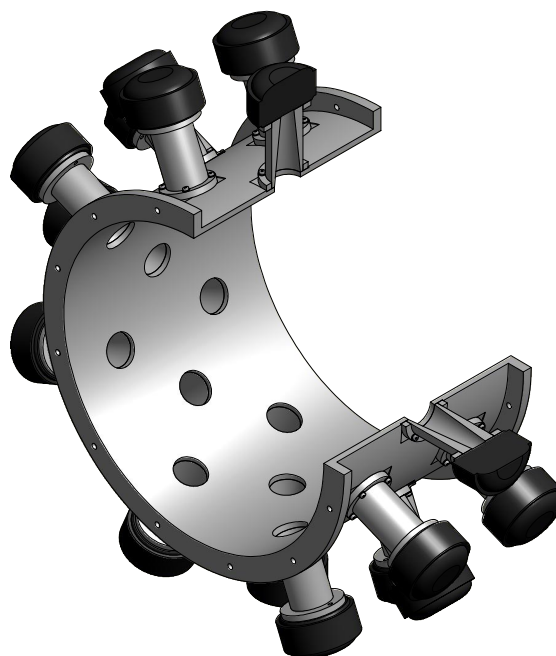
Abbildung 6.1: Aus drei Aktuatorringen bestehendes Lautsprecherarray in aufgeschnittener Darstellung. In jedem Ring können bis zu acht Lautsprecher mit äquidistantem azimuthalen Abstand und in Verbindung mit Trichtern bündig mit der Kanalwand installiert werden.
