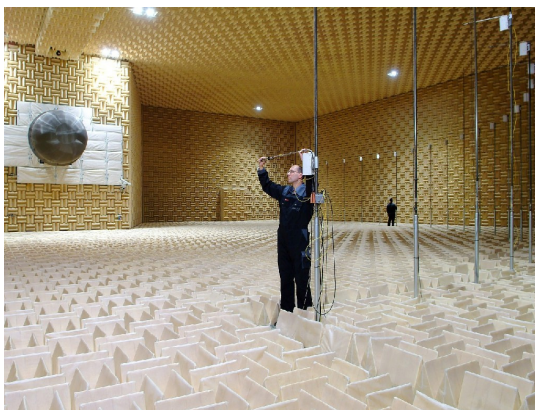
Abbildung G.1: Fan-Rig in der reflexionsarmen Versuchshalle der Firma AneCom AeroTest [93]. Der Einlauf des Fan-Rigs ist mit einem Turbulenzschirm versehen [134].
